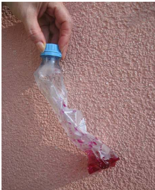
Fot. 6. Prostsza wersja doświadczenia 5. Podciśnienie w butelce wywołane pochłanianiem amoniaku przez wodę z dodatkiem fenoloftaleiny powoduje zgniecenie naczynia przez ciśnienie atmosferyczne.
