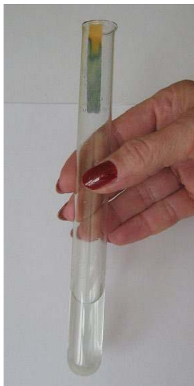
Fot. 3. Doświadczenia 1 i 2. Barwa papierka wskaźnikowego dowodzi, że wydzielany gaz to amoniak.
