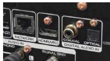
HDMI z ARC służy głównie do połączenia z telewizorem.
