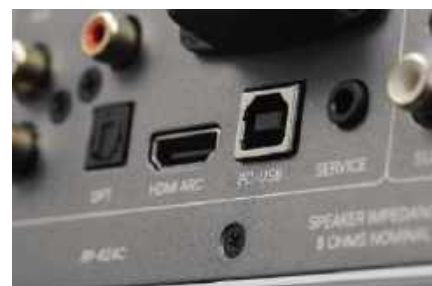
W części cyfrowej są dwa najważniejsze gniazda – HDMI (z ARC) oraz wejście USB-DAC.
