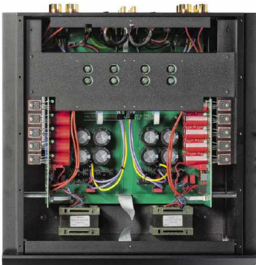
Z tyłu znajduje się sekcja lampowa, następnie sygnał jest prowadzony do dwóch niezależnych bloków końcówek mocy.
