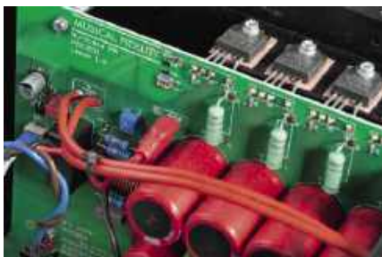
Tuż przy końcówkach znajdują się kondensatory zasilacza.
