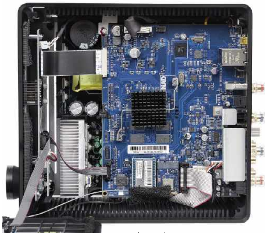
Górny (niebieski) moduł to obszar systemu BluOS, uzupełniony o inne układy cyfrowe, na dolnym poziomie znajdują się impulsowe końcówki mocy.
