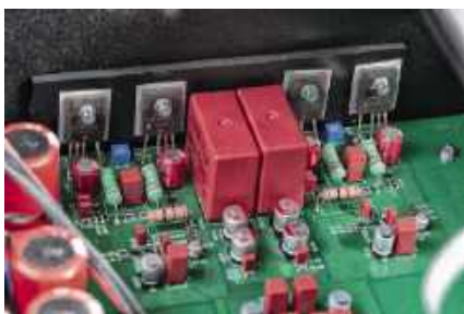
Sekcja wyjściowa PRE bazuje na czterech tranzystorach Sanken (w każdym kanale).
