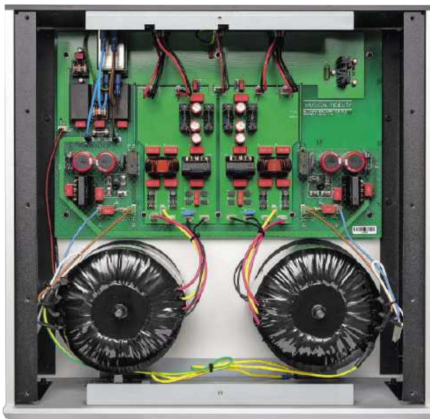
Obydwa zasilacze zbudowane są w konwencji dual-mono – z parą transformatorów toroidalnych i towarzyszących im filtrów. PAS ma oczywiście większe wymagania, więc i jego zasilacz jest bardziej wydajny, a połączenie obejmuje aż pięć kabli. Aby jednak nie zużywać energii elektrycznej niepotrzebnie (końcówka ma duży pobór prądu spoczynkowego), mniejsza sekcja służy oszczędnej sekcji czuwania.
