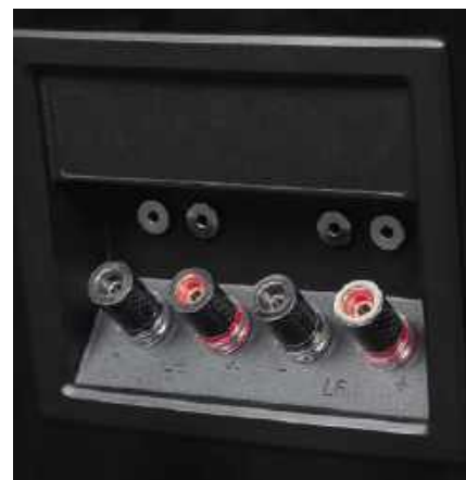
Dwie pary zacisków, oznaczone HF i LF, prowadzą sygnał odpowiednio do sekcji średnio-wysokotonowej (20-tki i tuby) i do głośnika niskotonowego. Znajdujące się powyżej gniazda służą do założenia nietypowych zwor, jednak nie były one obecne w testowanej parze, więc stosowaliśmy zwory z odcinków kabli.
