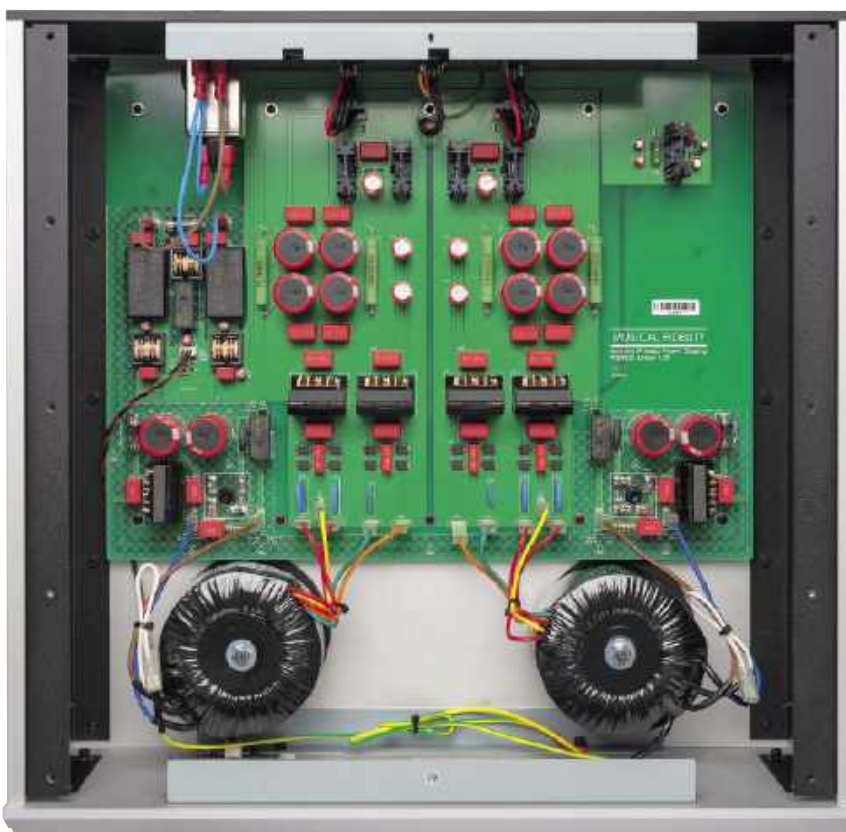
Urządzenia serii Nu-Vista nie mają wbudowanych zasilaczy, więc potrzebują zewnętrznych jednostek – zasilaczy PSU , zatem zarówno przedwzmacniacz PRE , jak i końcówka PAS mają formy "dwupudełkowe". Połączenia zasilaczy z PRE i PAS obejmują nie tylko linie zasilające, ale też komunikację kablem "Control"; dzięki temu po włączeniu PRE i PAS zasilacze wystartują automatycznie.
