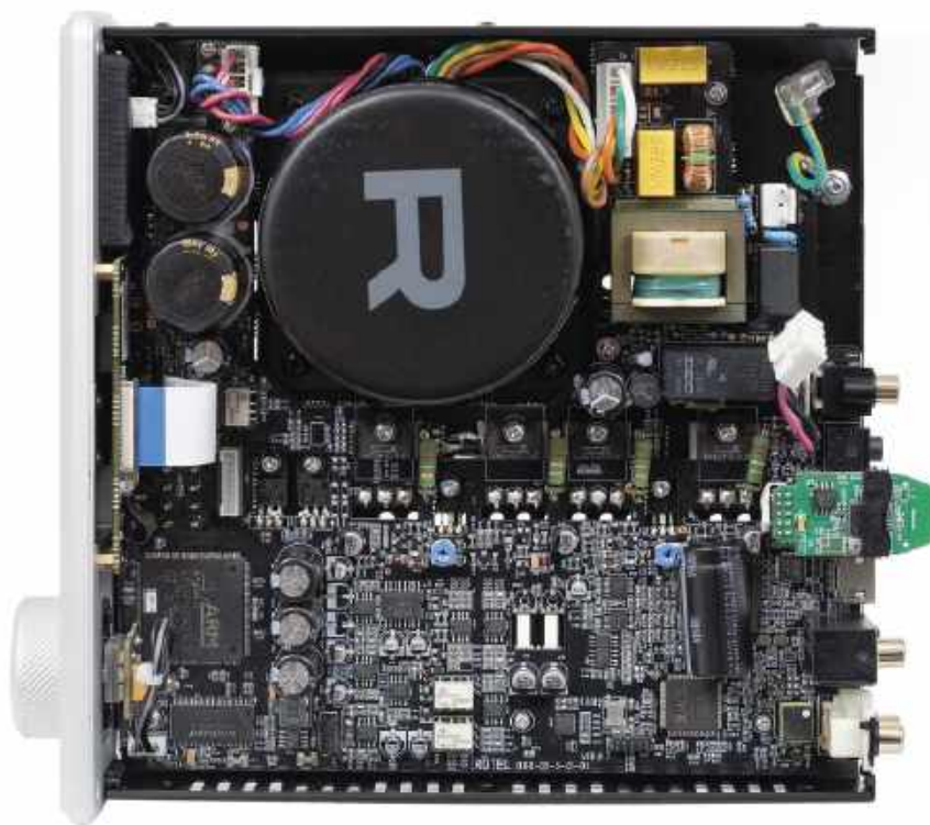
Mimo kompaktowych rozmiarów, DX-5 ma układy liniowe zarówno w końcówkach, jak i w zasilaczu.
