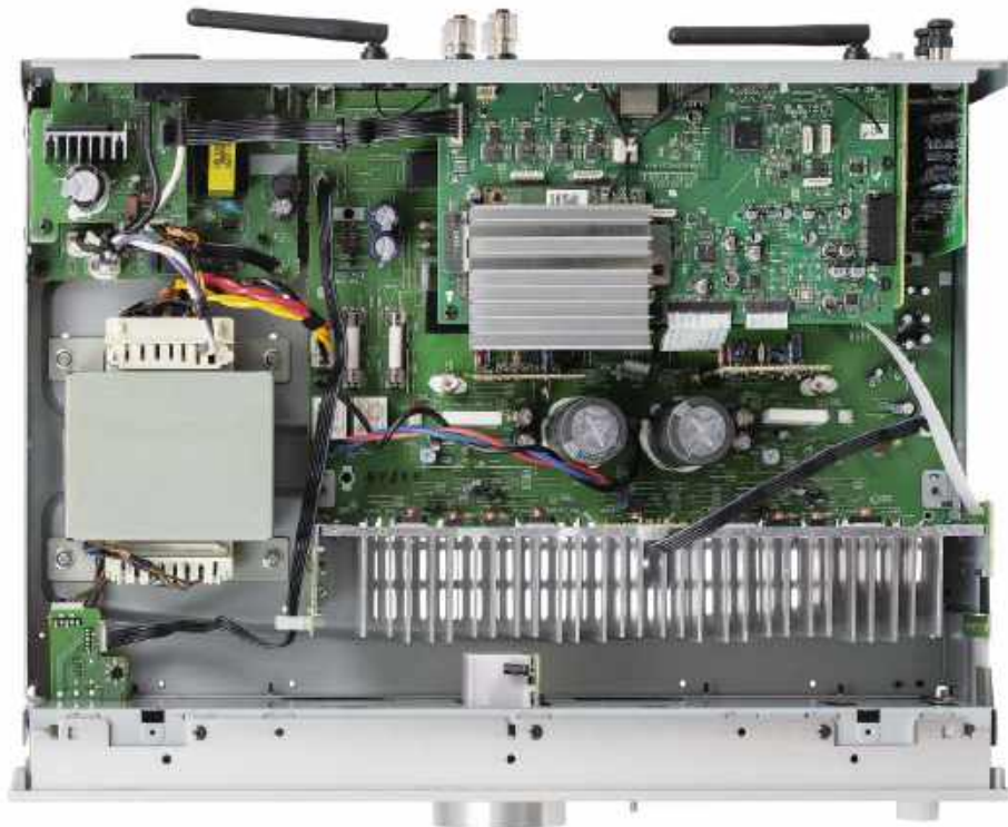
Rozplanowanie modułów przypomina nieco amplituner wielokanałowy, jednak poszczególne płytki są zaprojektowane specjalnie dla A-50 i czysto stereofoniczne.
