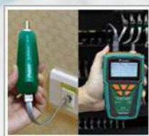
test kabli LAN, telefonicznych i koncentrycznych
