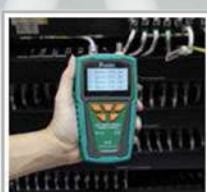
pomiar długości przewodu; lokalizacja punktu przerwania
