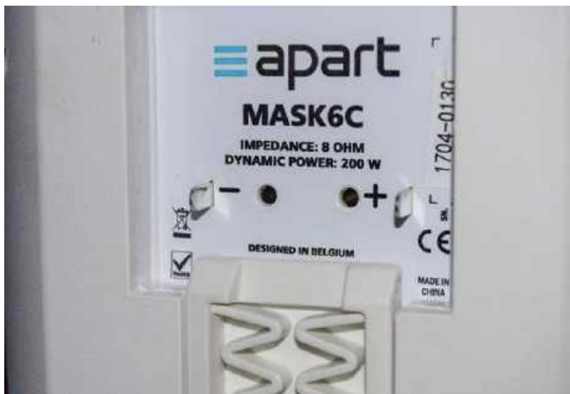
Szybkozłącze na tylnym panelu zestawu stanowią dwa męskie konektory, które wpinają się w element żeński na uchwycie ściennym.
