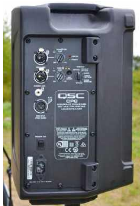
Z tyłu urządzenia znajduje się panel zawierający wszystkie gniazda sygnałowe, gniazdo i wyłącznik zasilania oraz manipulatory.
