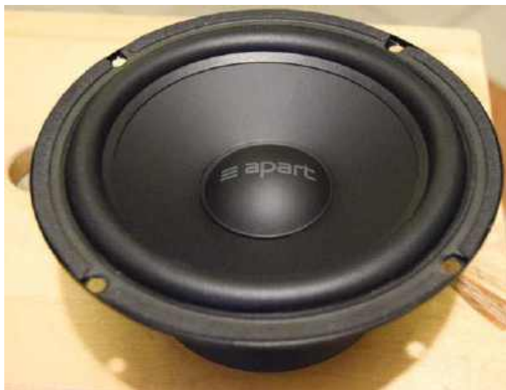
Za tony niskie i średnie odpowiada głośnik firmowany przez APART o średnicy membrany 6,5", wyposażony w magnes ferrytowy.
