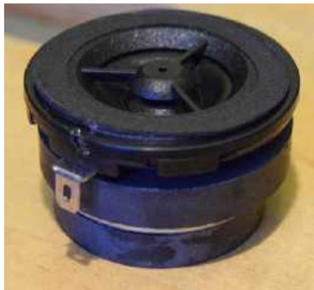
Za tony wysokie odpowiada driver o średnicy 1", również wyposażony w magnes ferrytowy.
