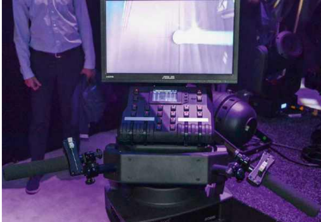
System śledzenia RoboSpot składa się m.in. z BaseStation, czyli sterownika, za pomocą którego operator kontroluje pozycję urządzeń oświetleniowych wykorzystywanych do śledzenia.
