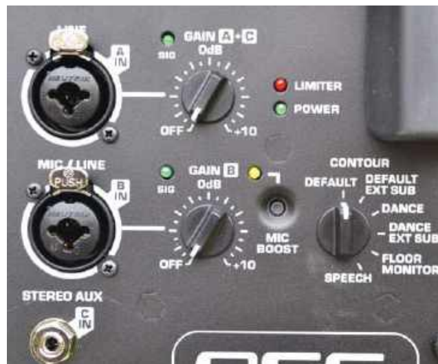
Do wyboru presetu brzmieniowego służy obrotowy 6-pozycyjny przełącznik na panelu tylnym.
