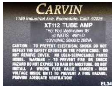
Producent informuje w nadruku, jakie lampy mocy zostały zastosowane we wzmacniaczu.
