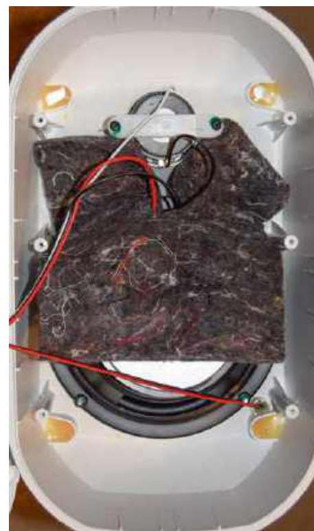
Wewnątrz obudowa MASK6C wyłumiona jest matą, aczkolwiek w niezbyt dużej ilości.
