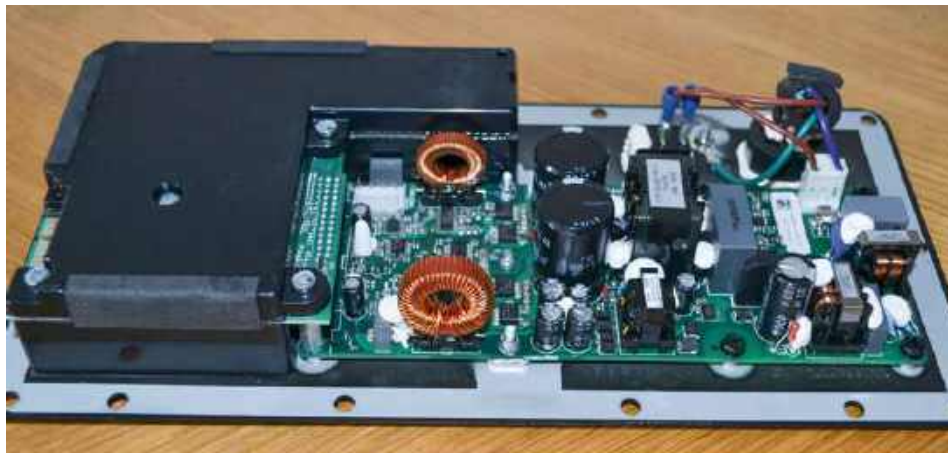
Cała elektronika mieści się na jednej płycie – DSP, układy wejściowe i końcówki mocy zamknięte są w szczelnej puszcze plastikowej.
