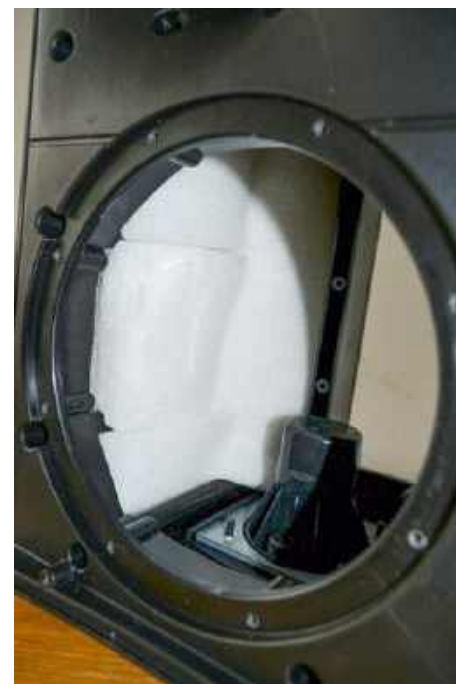
Obudowa wewnątrz jest wytłumiona matą wełnianą.
