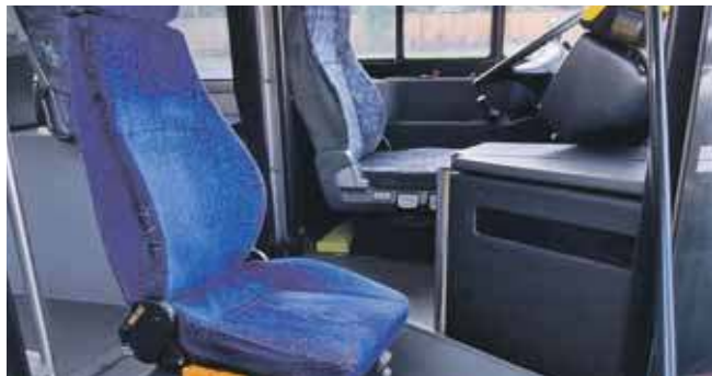
Autobus został wyposażony w dodatkowy fotel dla instruktora i dodatkowy pedał hamulca
