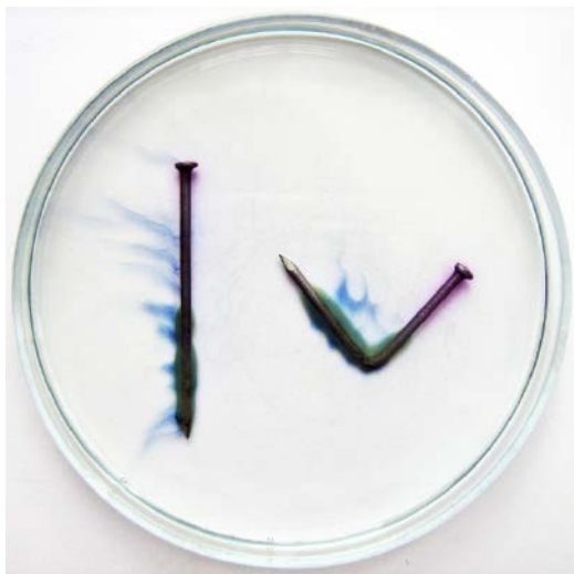
7. Przyspieszona korozja zachodzi w miejscach obróbki mechanicznej (ostrze i zgięcie gwoźdźcia)
