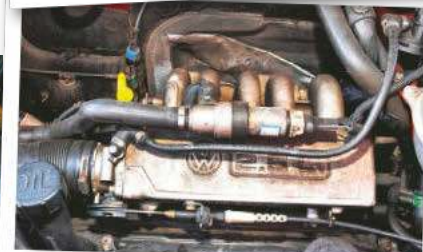
Benzynowy 2.5: wytrzymałość mechaniczna jest wysoka, czasami strajkuje wtrysk.
