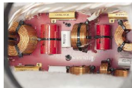
To prawdopodobnie sekcja zwrotnicy dla 18-tek – jak na układ dwóch filtrów dolnoprzepustowych jest bardzo skomplikowana.
