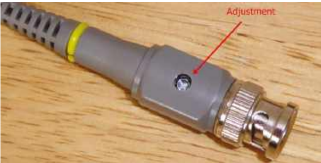
Fotografia 13. Regulacja kompensacji przy złączu do wejścia oscyloskopu
