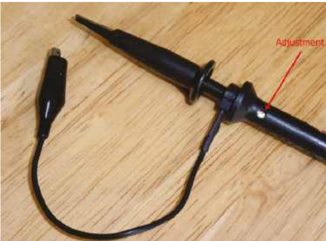
Fotografia 12. Regulacja kompensacji przy końcówce sondy oscyloskopowej
