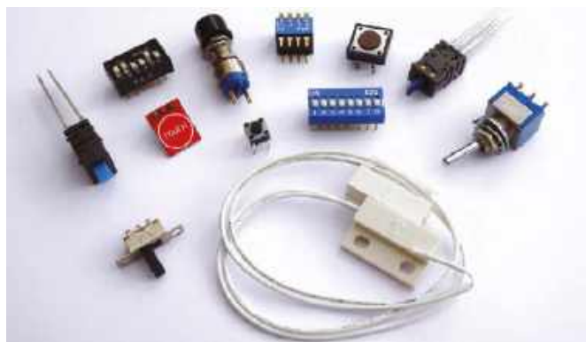
Rysunek 2.11. Popularne typy przycisków i przetworników, idealne do stosowania z ESP32
