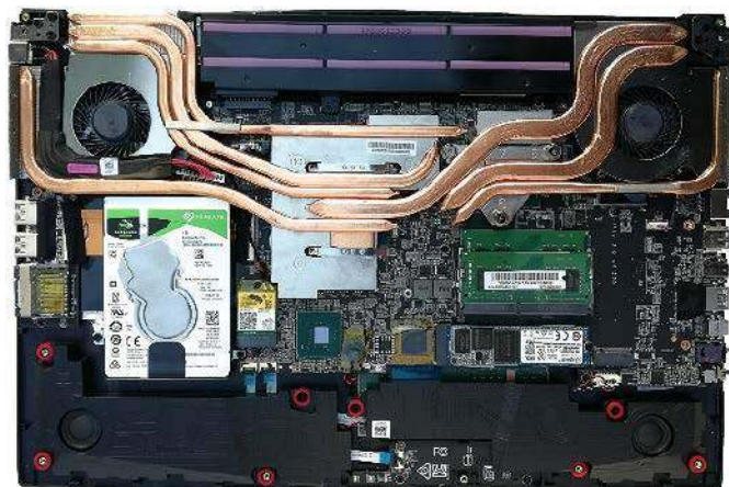
Fotografia 29. Wnętrze laptopa z widocznym systemem rurek ciepła oraz dwoma wentylatorami promiennymi ( http://t.ly/XSYea )
