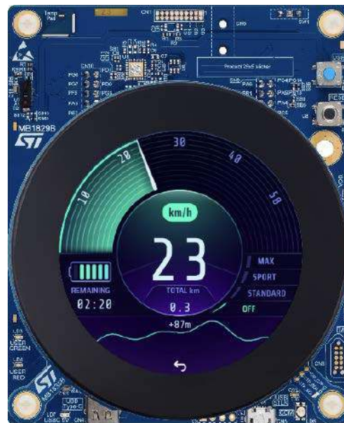
Rysunek 3. Zestaw deweloperski Discovery z układem STM32U5A9NJH6Q do testowania możliwości graficznych układu
