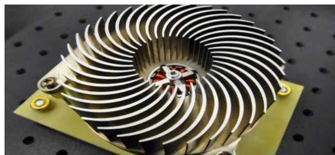
Fotografia 11. Interesujący przykład radiatora, który stanowi jednocześnie... wirnik wentylatora ( http://t.ly/g6HZR )
