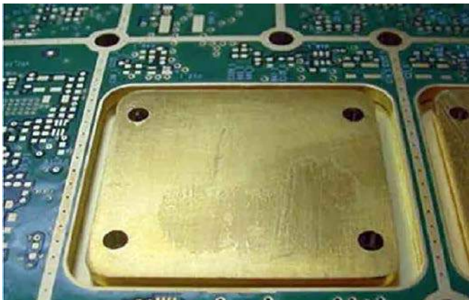
Fotografia 34. PCB z wkładką miedzianą ( copper coin ) umieszczoną we wnętrzu PCB ( cavity ) ( http://t.ly/0Z9xW )
