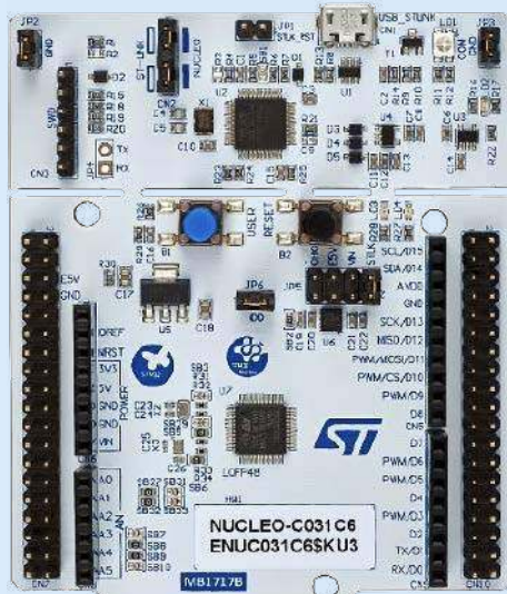
Fotografia 2. Widok płytki ewaluacyjnej NUCLEO-C031C6 ( http://t.ly/QLij7 )
