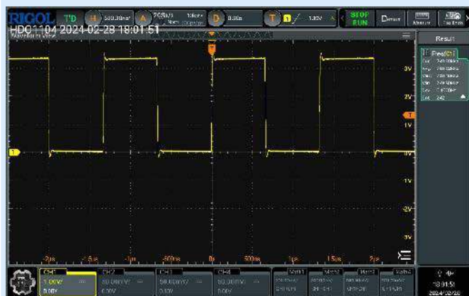
Rysunek 13. Przebieg na wyjściu MCO2
