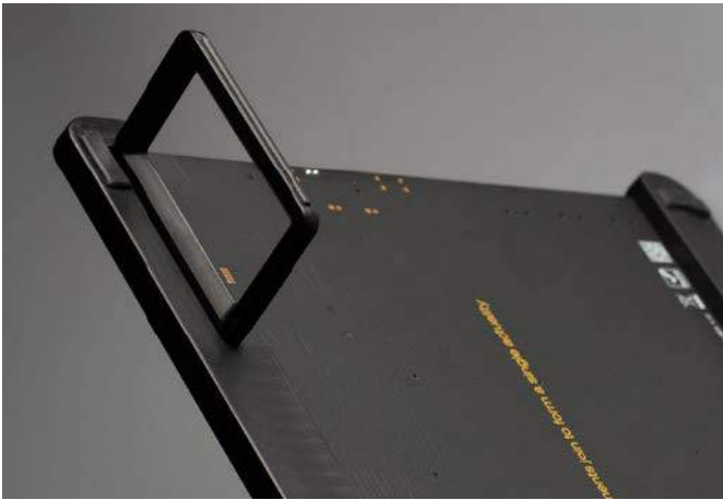
Fotografia 8. Zintegrowane podpórki przymocowane do płyty z serii Fusion marki MikroElektronika ( http://t.ly/P7JLj )
