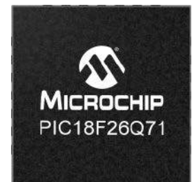
Rysunek 2. Procesory z rodziny PIC18-Q71 firmy Microchip zawierają szereg inteligentnych, analogowych bloków peryferyjnych, w tym różnicowy przetwornik analogowo-cyfrowy (ADC)
