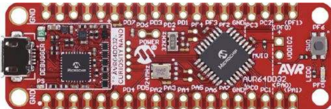
Rysunek 2. AVR4DD32 Curiosity Nano Evaluation kit firmy Microchip
