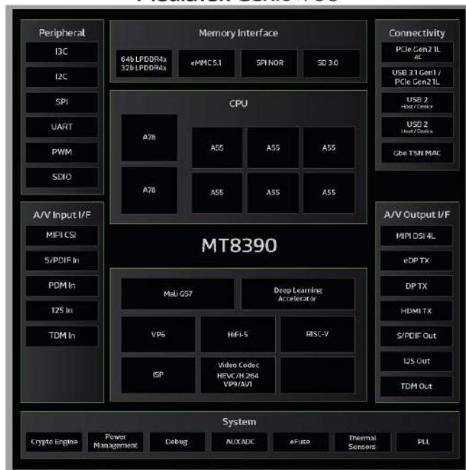
Rysunek 1. Uproszczony schemat blokowy procesora MediaTek Genio 700 (t.ly/WO8Cm)
