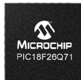
Rysunek 2. Procesory z rodziny PIC18-Q71 firmy Microchip zawierają szereg inteligentnych, analogowych bloków peryferyjnych, w tym różnicowy przetwornik analogowo-cyfrowy (ADC)
