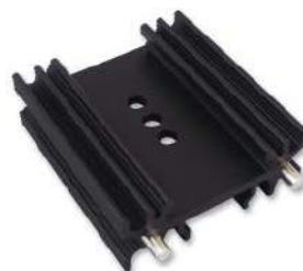
Fotografia 8. Radiator kompatybilny z obudową TO-220. Widoczne otwory do przykręcenia komponentu oraz piny do mocowania w otworach PCB metodą lutowania przewlekane ( http://t.ly/R5hgX )
