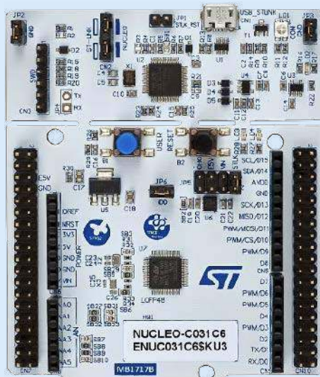
Fotografia 2. Widok płytki ewaluacyjnej NUCLEO-C031C6 ( http://t.ly/QLij7 )
