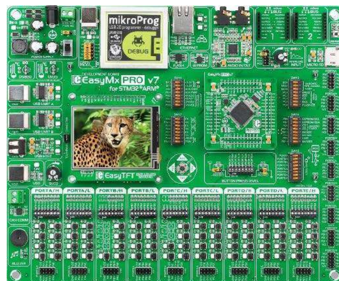
Fotografia 5. Płyta bazowa 7. generacji – EasyMx PRO v7 for STM32 marki MikroElektronika ( http://t.ly/9ospP )
