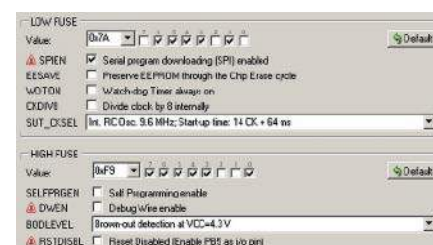
Rysunek 3. Szczegóły ustawienia bitów zabezpieczających
