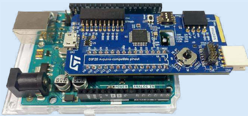
Fotografia 1. Dowód na to, jak firma ST Microelectronics próbuje podbić rynek 8-bitowców za pomocą nowej rodziny STM32C0 – moduł STM32C016-DK w roli zamiennika oryginalnego procesora ATmega328 na płytce Arduino Uno (źródło: nota aplikacyjna AN5780)
