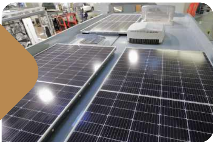
Panele fotowoltaiczne zmniejszają moc, gdy temperatura modułu wzrasta, a zwiększają, gdy temperatura maleje. Powinno się przyjąć, że instalacja dachowa rozgrzeje się nawet do 65 i więcej stopni Celsjusza
