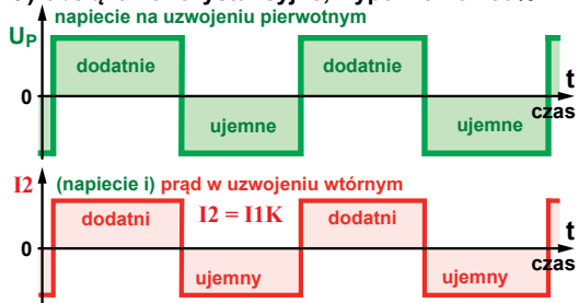
b) obciążenie rezystancyjne, wypełnienie <50%
