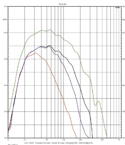
Rys. 3. Charakterystyki dla różnych częstotliwości filtrowania (40 Hz, 100 Hz, 200 Hz, LFE), obudowa zamknięta, profil Music.
