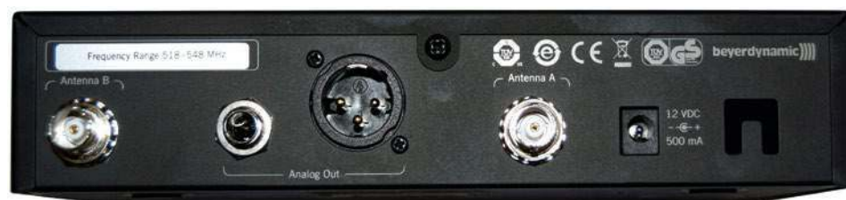
Na tylnym panelu odbiornika znajdują się gniazda BNC dwóch odłączanych anten oraz gniazda wyjściowe – XLR i jack ¼".
