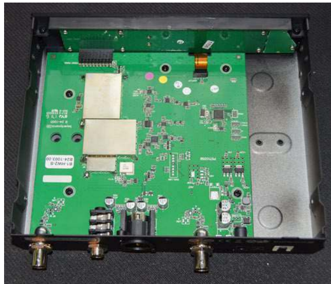
Zaglądną do wnętrza odbiornika stwierdzamy, że składa się z dwóch płyt drukowanych, wykonanych w technologii SMD.
