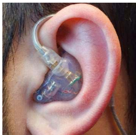
Doskonale znana marka Sensaphonics oferuje zintegrowany, obuuszny mikrofon, przekazujący dźwięk z otoczenia o kierunkowości 3D.
