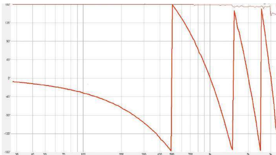
Rysunek 6. Charakterystyka fazowa sygnału o stałym opóźnieniu z logarytmiczną osią częstotliwości – wykres, wraz ze wzrostem częstotliwości, opada logarytmicznie.
