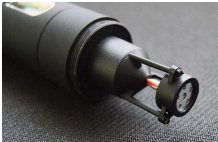
W nadajniku TG 500H-C zastosowano pojemnościową kapsułę Beyerdynamic TG V56 o charakterystyce kardioidealnej.
