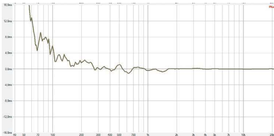
Rysunek 4. Przykładowa charakterystyka opóźnienia grupowego (group delay) zestawu głośnikowego.
