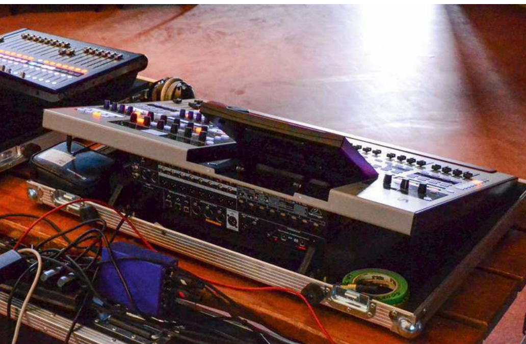
WING zapewnia 3 porty sieciowe audio AES50 SuperMAC do podłączenia zewnętrznych urządzeń lub współdzielenia do 144 strumieni wejściowych i 144 strumieni wyjściowych z innymi konsolami miksującymi.
