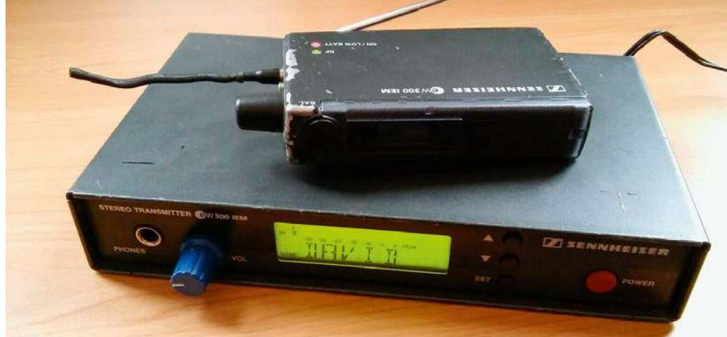
U progu milenium niemiecki producent, firma Sennheiser, zadebiutowała na rynku własnym systemem ew300 IEM, który oferował, co prawda, ograniczoną, ale jednak pewną możliwość wyboru częstotliwości pracy.
