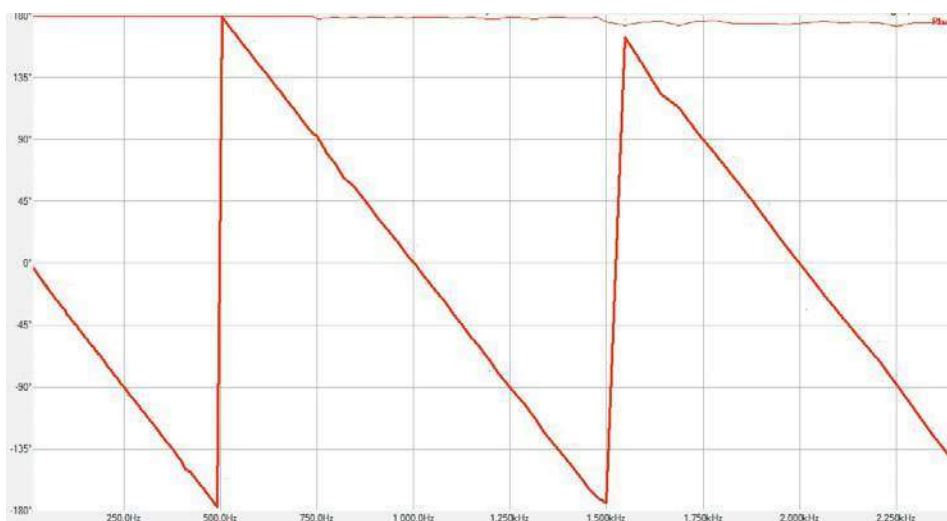
Rysunek 5. Charakterystyka fazowa sygnału o stałym opóźnieniu z liniową osią częstotliwości – wykres opada liniowo wraz ze wzrostem częstotliwości.
