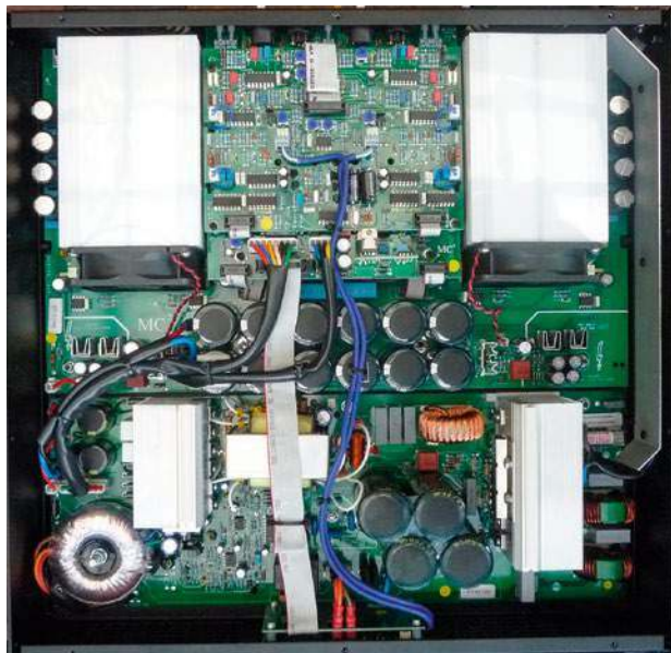
Zaawansowana, wysokiej klasy końcówka mocy z zasilaniem impulsowym, pracująca w klasie D.
