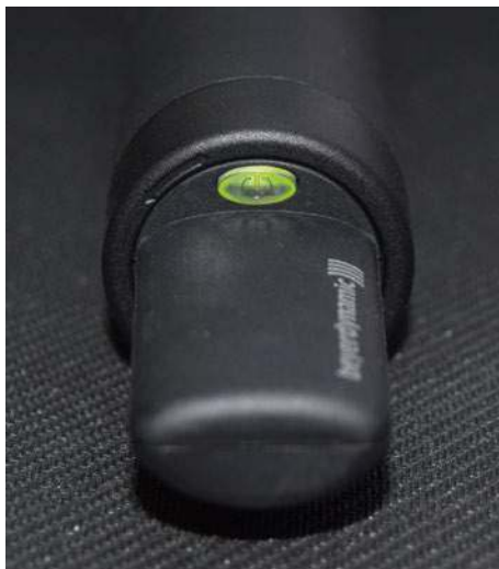
W dolnej części obudowy nadajników handheld znajduje się osłona anteny nadawczej oraz podświetlany na kolor zielony dwufunkcyjny przycisk.
