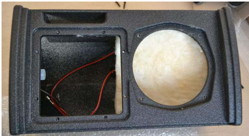
Wnętrze obudowy VR5 jest lekko wytłumione cienką warstwą waty szklanej...
