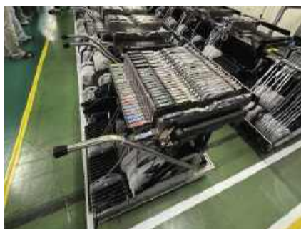
Na specjalnych wózkach montowane są szpule z elementami SMD.
