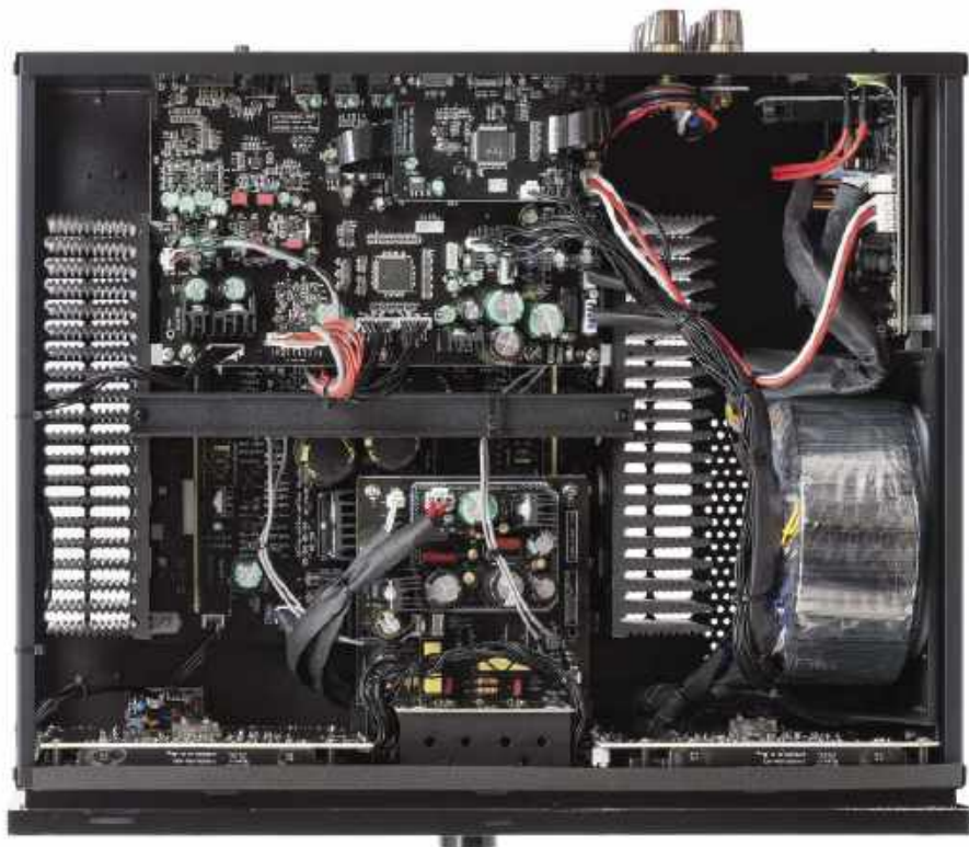
W A10 Apex połączono różne techniki wzmacnienia i różne sygnały, ale mimo wielu połączeń i zastosowania lamp, odstęp od szumu jest co najmniej dobry.
