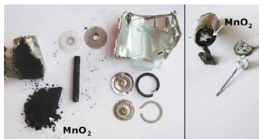
2. Rozłożone ogniwa zawierające dwutlenek manganu: z lewej ogniwo Leclanchégo, z prawej ogniwo alkaliczne (opis w tekście)
