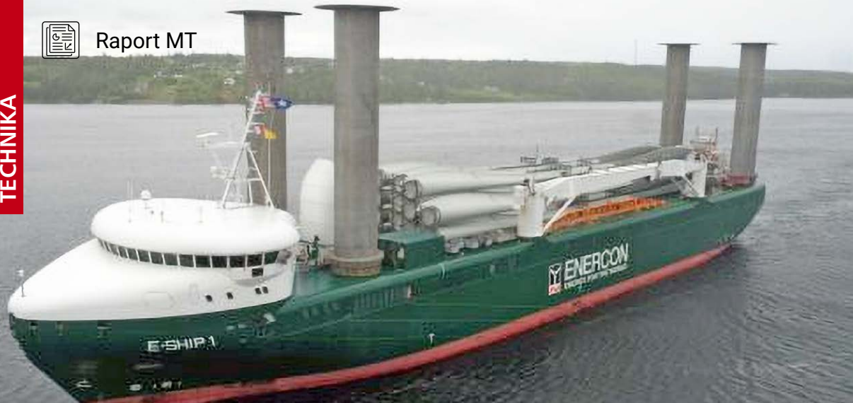
Statek E-ship 1 wyposażony w cztery rotory z ładunkiem elementów morskiej farmy wiatrowej ( https://northsearegion.eu/wasp/our-technologies/flettner-rotor-eco-flettner/how-it-works-flettner-rotor/index.html , źródło: IWSA)
