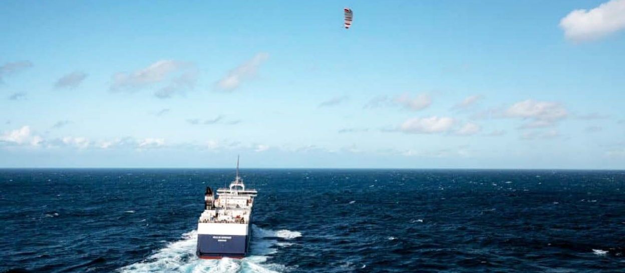
Żagiel latawcowy Seawing od przedsiębiorstwa Airseas podczas rejsu testowego (2023). Fot. PolaRYSE/Maxime Horlaville ( https://airseas.com/en/new-technical-milestone-seawing-kite-tows-ships/ )
