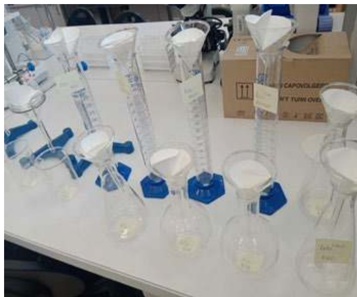
Fot. 2. Przygotowanie zestawu do sączenia roztworów.
