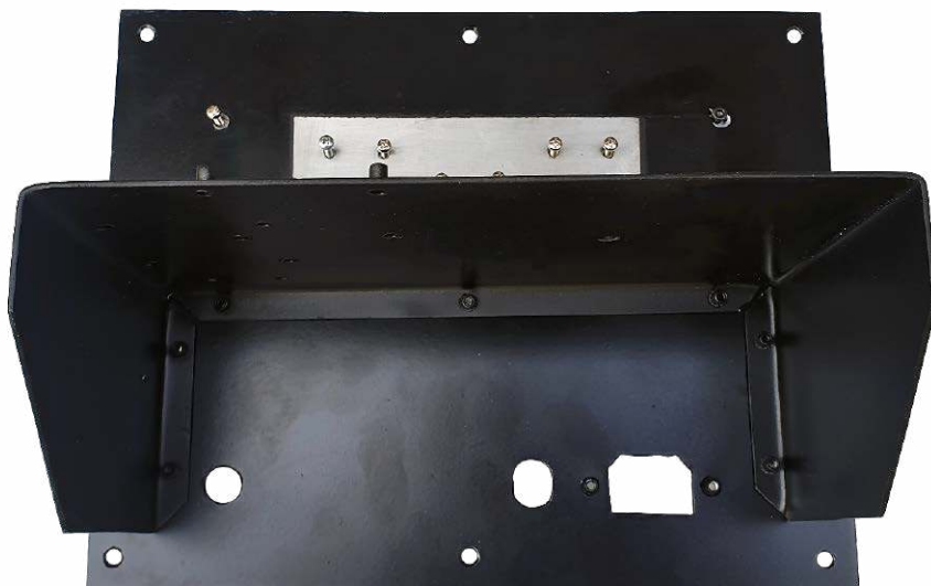
Fotografia 11. Na tym wsporniku zamontowana jest większość elementów modułu wzmacniacza
