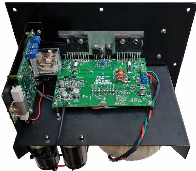
Fotografia 15. Widok od strony wzmacniacza po zakończeniu montażu i okablowania
