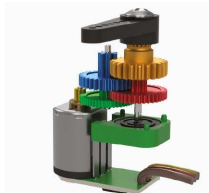
Rysunek 8. Serwomechanizm w obudowie (u góry) i bez obudowy (u dołu). Rysunek: Steve Manley
