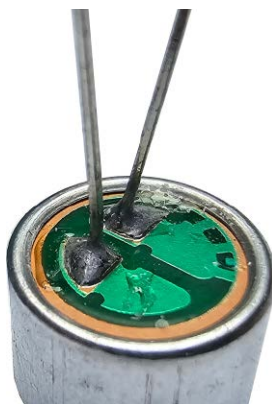
Fotografia 3. Wyprowadzenia mikrofonu elektretowego; wyprowadzenie połączone z metalowym korpusem stanowi biegun ujemny („minus“)
