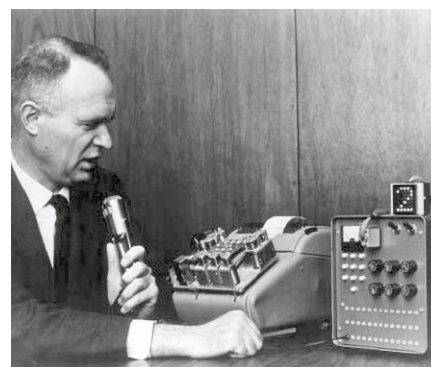
Rysunek 14. System rozpoznawania głosu/kalkulator IBM „Shoebbox”. Źródło: IBM
