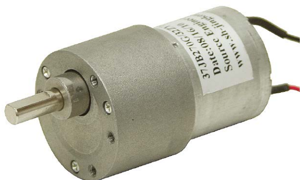
Rysunek 1. Silnik z przekładnią – zwróć uwagę, że przekładnia jest przymocowana bezpośrednio do korpusu silnika, co zapewnia kompaktową konstrukcję całości. Widoczny jest typowy wał wyjściowy z przekrojem w kształcie litery D. Prezentowany motoreduktor jest przeznaczony do pracy przy napięciu 24 V i obraca się z prędkością 25 obr./min (150°/s) bez obciążenia. Kosztuje zaledwie 6 funtów
