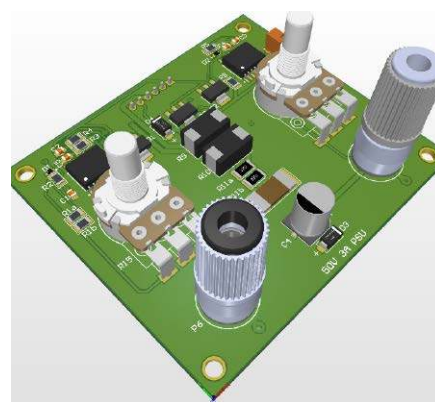
Rysunek 4. Trójwymiarowy widok projektu płytki stabilizatora 50 V
