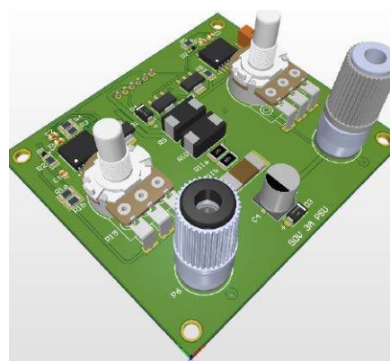
Rysunek 4. Trójwymiarowy widok projektu płytki stabilizatora 50 V
