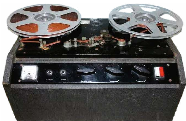
Rysunek 15. Magnetowid domowy Telcan, wykorzystujący ćwierćcalową dźwiękową taśmę magnetofonową, sprzedawany głównie jako zestaw do montażu. Źródło: www.nottinghampost.com/news/history/20-best-things-nottingham-given-192680
