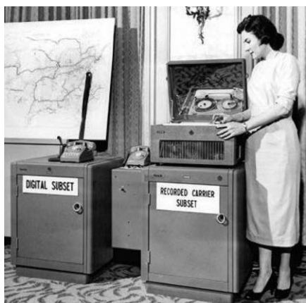
Rysunek 10. Modem Bell 101, wyprodukowany przez AT&T w 1958 r. Źródło: https://history-computer.com/modem-complete-history-of-the-modem/
