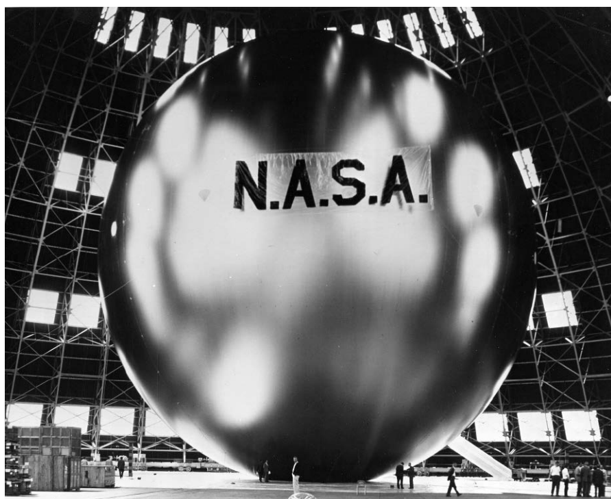
Rysunek 11. Satelita ECHO 2 w trakcie testowania i kontroli, górujący nad otaczającymi go ludźmi. Pierwsza transmisja poprzez tego satelitę odbyła się z Kalifornii do New Jersey w 1960 roku. Źródło: NASA
