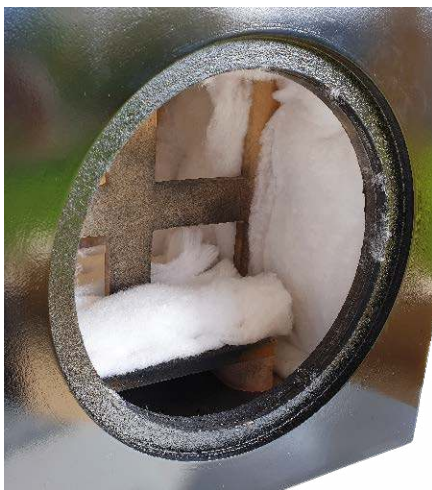
Fotografia 16. Materiał tłumiący zamocowany zszywaczem, stosując podwójną warstwę włókna poliestrowego. Jest to konieczne do tłumienia fal akustycznych emitowanych przez tylną stronę głośnika oraz ograniczenia rezonansów
