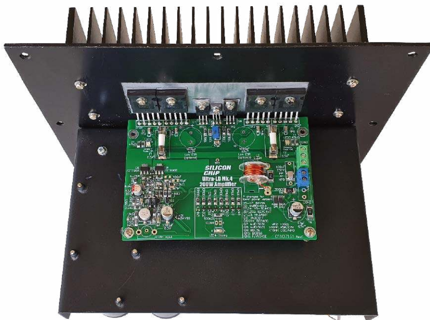
Fotografia 12. Wzmacniacz Ultra-LD Mk.4 zamontowany na wsporniku, gotowy do podłączenia
