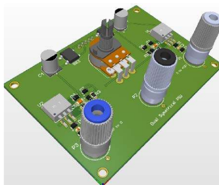
Rysunek 8. Trójwymiarowy widok projektu płytki symetrycznego zasilacza regulowanego
