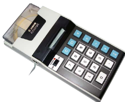
Rysunek 18. Canon Pocketronic – pierwszy dostępny handlowo ręczny kalkulator elektroniczny. Źródło: https://w.wiki/7EG3 (CC-BY-SA-4.0)
