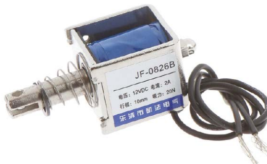
Rysunek 8. Typowy elektromagnes ogólnego przeznaczenia ze sprężyną zwrotną. Ten model jest przeznaczony do pracy przy napięciu 12 V, pobiera prąd o natężeniu 2 A i ma maksymalną siłę przyciągania 20 N (około 2 kg). Jego koszt jest niski – tylko około 4 funtów
