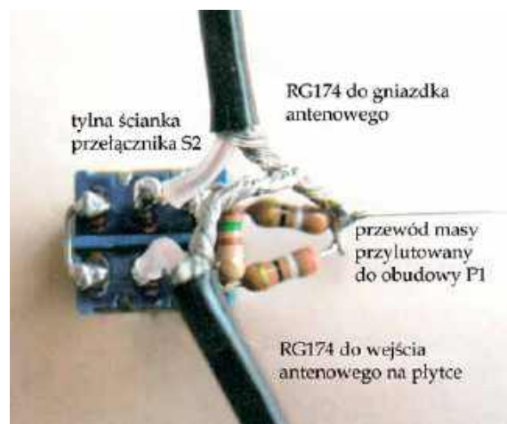
Rys. 6. Sposób podłączenia mechanicznego filtra FZ01 – FZ103
