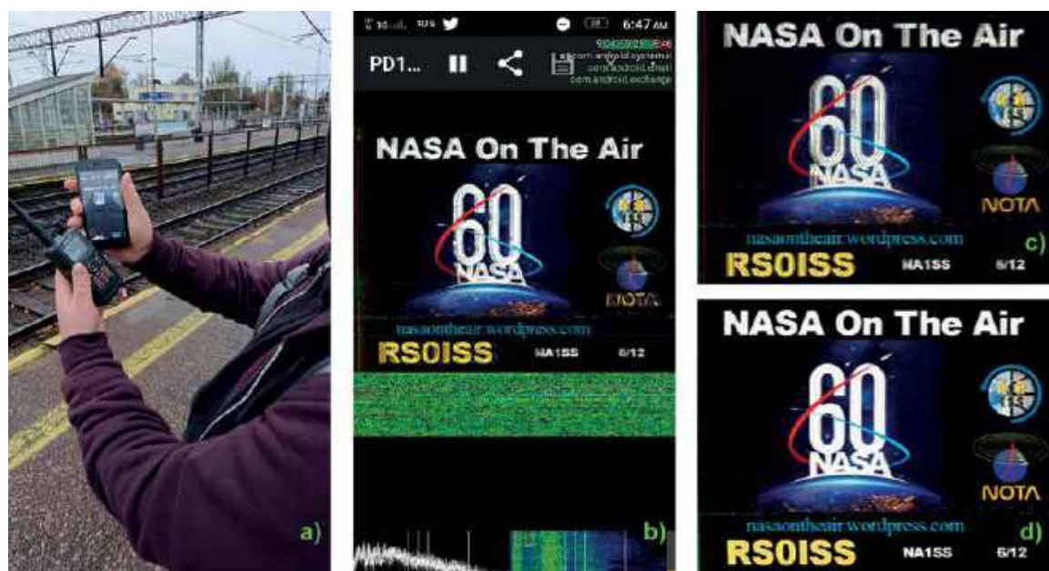
Rys. 14. Radiostacja TH-D74E była wykorzystywana do odbioru obrazów nadawanych z pokładu ISS i nagrywania odebranego dźwięku na kartę microSD. Na stacji (a) w Kutnie odbyła się prezentacja odbierania „melodii” nadawanej z Międzynarodowej Stacji Kosmicznej (Fot. M. Baran). Do celów prezentacji, co zawiera „melodia”, (b) dźwięk z głośnika TH-D74E był odbierany przez mikrofon telefonu z systemem Android i dekodowany aplikacją Robot36. Dźwięk nagrany na karcie microSD w TH-D74E był później skopiowany do komputera i zdekodowany programem MMSSTV (d). Nie widać z tak nagranego pliku dźwiękowego niezgodności związanej z niedopasowaniem próbkowania dźwięku cyfrowego, który może być widoczny na zdekodowanych obrazach w postaci ukośnych pasów lub kropek podobnych do tych jak na (c)
