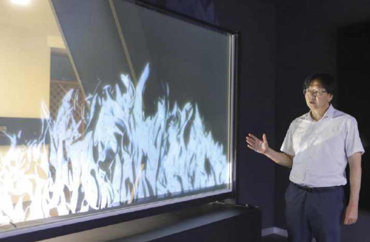
1. 100-calowy nanoprzeczroczysty ekran (NTS) cienki jak ludzki włos © Korea Institute of Machinery and Materials
