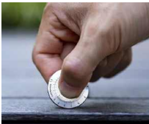
5. Tiroler jest trzymany za wewnętrzny pierścień i obracany jak koło podczas pomiaru © Titaner
