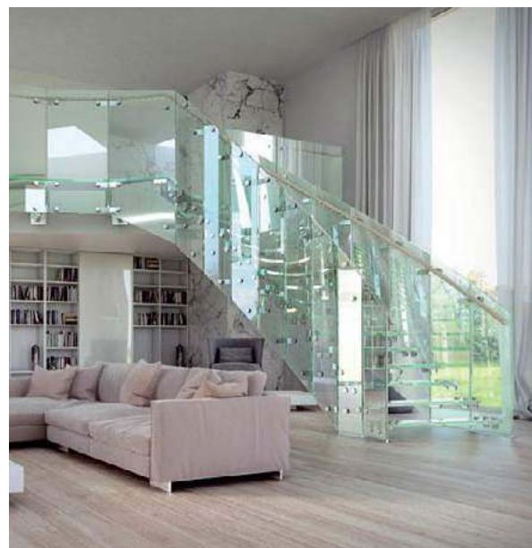
i Schody oraz balustrada w całości wyprodukowane ze szkła klejonego warstwowo. Metalowe są tu jedynie elementy mocujące. TIERSPOL
