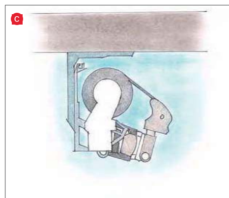
🔗 Sposoby mocowania markiz: do krokwi dachowej (a), do ściany (b) do sufitu (c).
