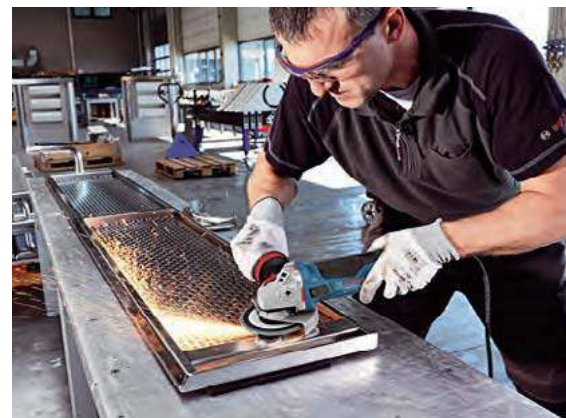
🔌 Szlifierkę kątową można wykorzystać do cięcia (a) i szlifowania (b). BOSCH
