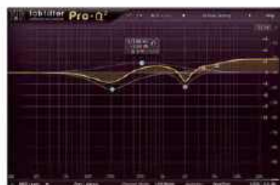
← Partia fortepianu odtwarzana jest przez Spectrasonics Keyscape, z którego sygnał trafia na kompresor UAD Teletronix LA-2A, emulator magnetofonu UAD Ampex ATR-102, korektor FabFilter Pro-Q2 i Waves Abbey Road Vinyl.
