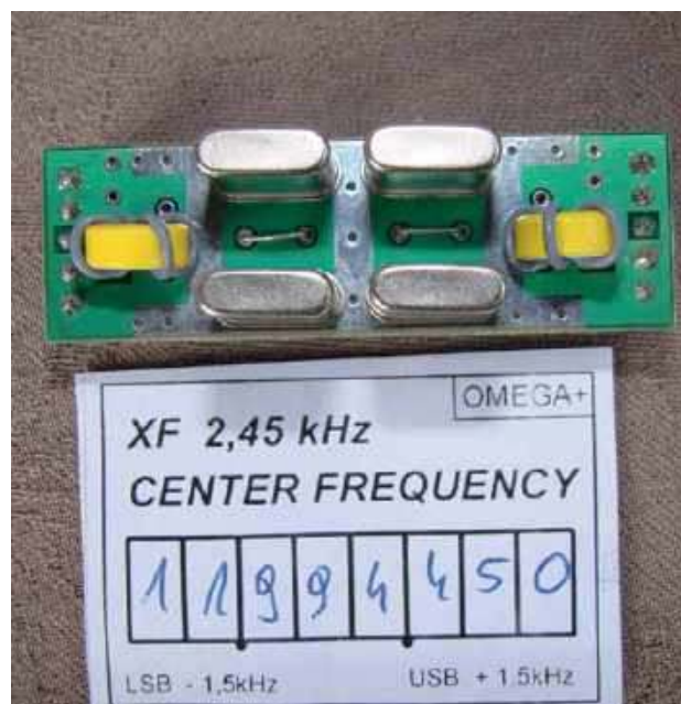
Filtr kwarcowy 12 MHz stosowany w TRX OMEGA
