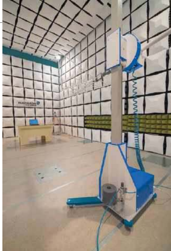
Stanowisko pomiarowe do badań emisji promieniowanej
