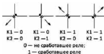
Rys. 5. Zmiana kierunku promieniowania za pomocą przełączeń przeciwwag i kondensatorów
