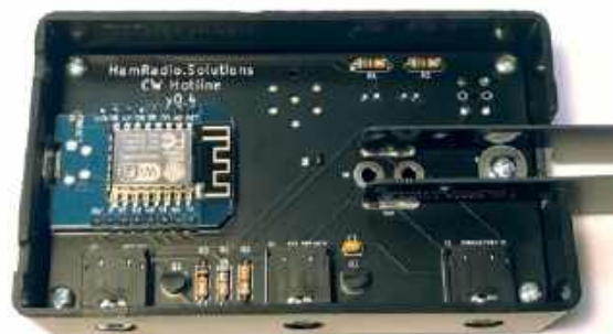
Konstrukcja z wmontowanym kluczem bocznym. Ramiona klucza są widoczne po prawej stronie płytki, a moduł mikrokomputera po lewej
