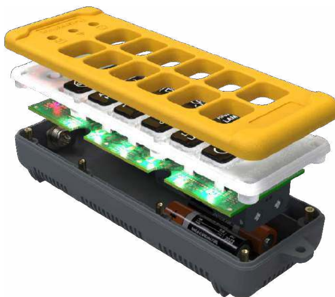
Rysunek 8 Przykład urządzenia, w którym płyta główna elektroniki pełni funkcję dolnej warstwy klawiatury
