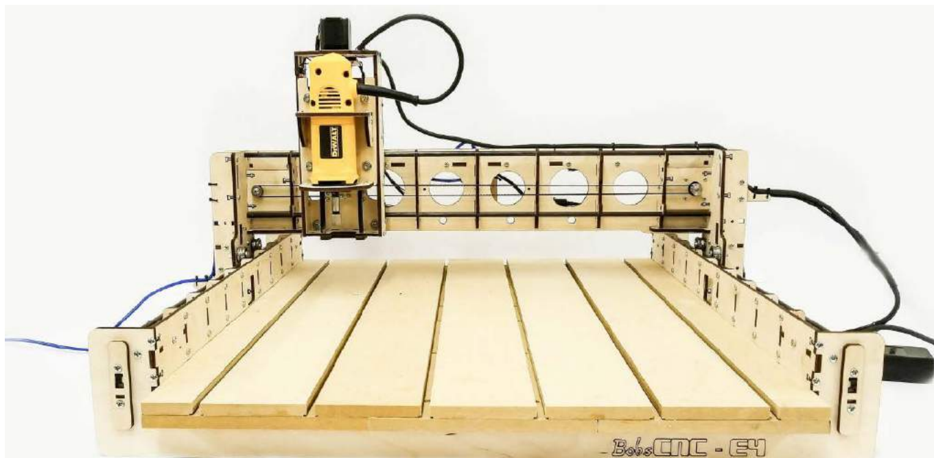
Fotografia 6. Średniej klasy router BobsCNC E4
