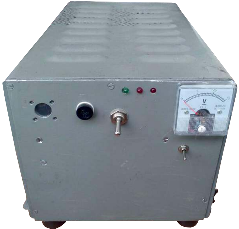
Widok zasilaczy WN DC (Ua i Us2) od strony płyty frontowej
