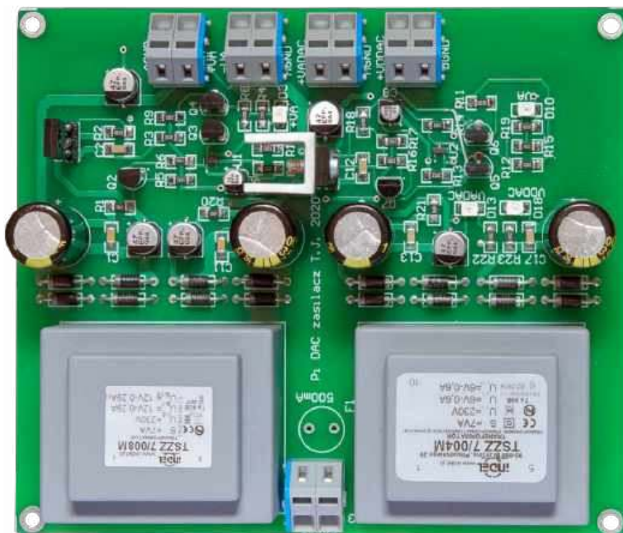
Fotografia 3. Zmontowany moduł zasilacza
