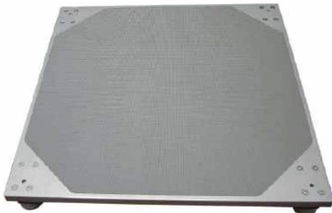
Fotografia 13. Tensometryczna platforma wyskokowa
