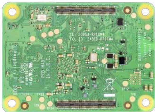
Fotografia 1. Moduł CM4 pokazany od strony złączy (z materiałów raspberrypi.org)
