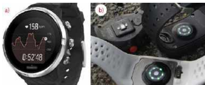
Fotografia 7. Smartwatch z pomiarem tętna: a) wyświetlacz, b) czujniki pomiaru tętna (źródło: https://bit.ly/38AzeUX )
