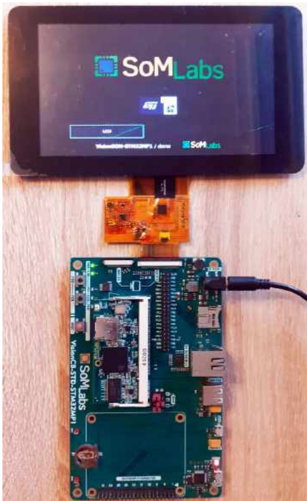
Fotografia 1. Uruchomiony system z aplikacją demo na VisionSOM-STM32MP1
