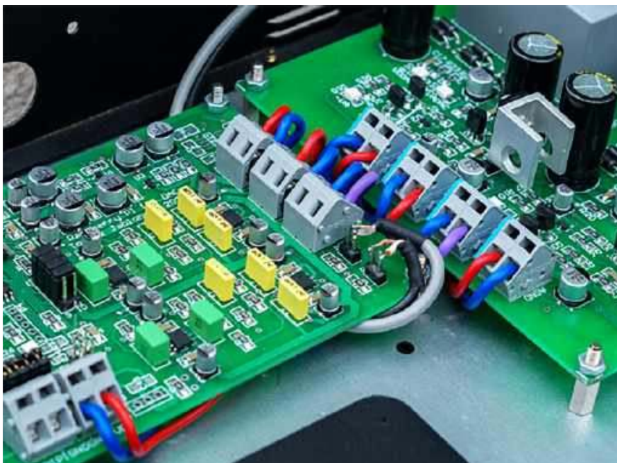
Fotografia 6. Połączenia pomiędzy modułem zasilacza i przetwornika
