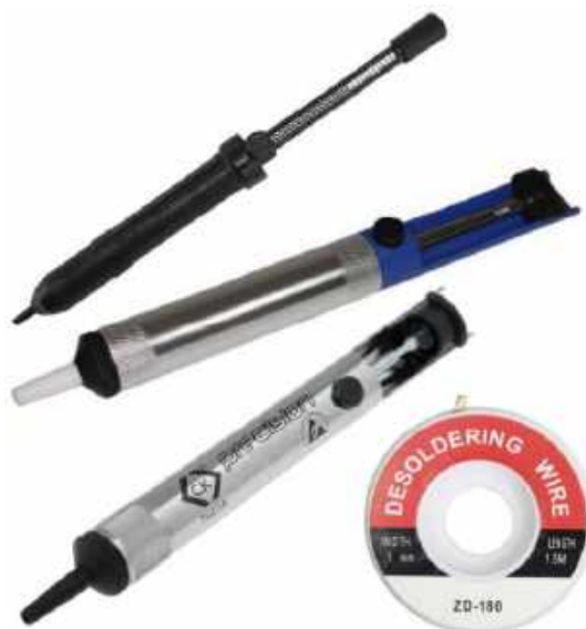
Fotografia 11. Odsysacze cyny i plectonka do rozlutowywania
