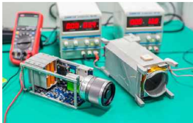
Fotografia 1. Przybliżona konstrukcja nanosatelite Światowid, zbudowanego przez firmę SatRevolution
