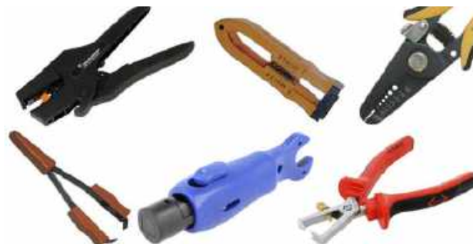
Fotografia 13. Różne typy przyrządów do ściągania izolacji
