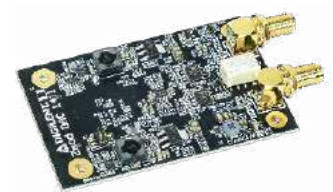
Fotografia 3. Wygląd ekspandera SYZYGY ZmodDAC1411 – 14-bitowego przetwornika C/A o częstotliwości próbkowania do 100 MHz
