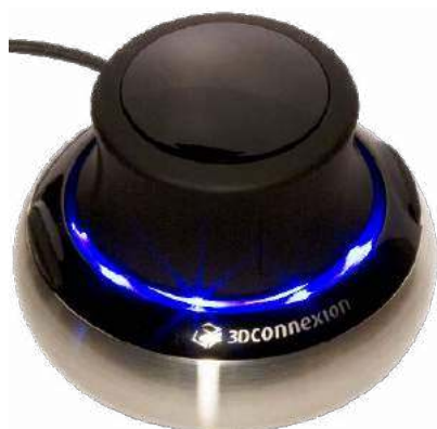
Fotografia 1. Urządzenie wejściowe SpaceNavigator z sześcioma stopniami swobody (commons.wikimedia.org)
