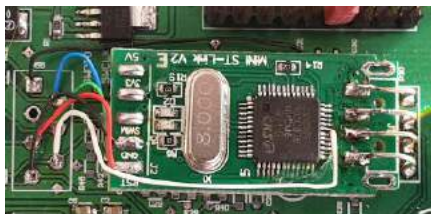
Fotografia 2. Sposób montażu programatora-debuggera dla mniej zaawansowanych
