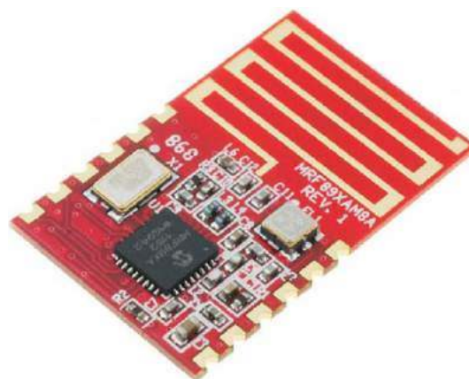
Fotografia 5. Moduł MRF89XAM8A pracujący w paśmie 863...870 MHz
