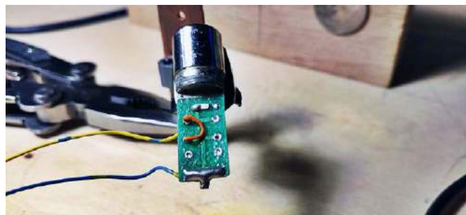
Fotografia 2. Dolutowana zwora, zastępująca przycisk chwilowy w module lasera
