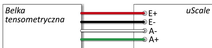
Rysunek 5. Sposób podłączenia belki tensometrycznej do urządzenia µScale
