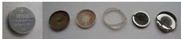
Ogniwo CR2032 i wyniki jego demontażu (od lewej): ogniwo przed otwarciem; anoda z naniesionym litem; separator nasączony niewodnym roztworem elektrolitu; izolujący pierścień z tworzywa sztucznego; warstwa dwutlenku manganu (katoda); obudowa stanowiąca wyprowadzenie katody.
