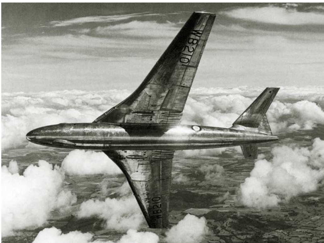
Pierwszy prototyp Valianta (WB210). Samolot miał skrzydła o skosie 37° w sekcjach przykadłubowych i 21° w sekcjach zewnętrznych, dzięki czemu zwiększono krytyczną liczbę Macha, zachowując zarazem dobre charakterystyki sterowności i przeciągnięcia.
