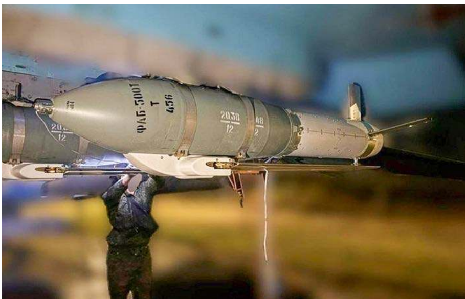
Nowa rosyjska bomba szybiąca FAB-500T UMPK z dodatkowym silnikiem odrzutowym, z którym deklarowany zasięg dochodzi do 200 km.
