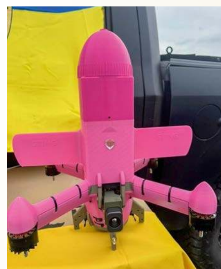
Wielowirnikowiec przechwytyjący STING może zwalczać cele w promieniu do 25 km od miejsca startu. Na zdjęciu specjalna edycja w różowym kolorze dostarczana do pododdziałów kobiecych.
