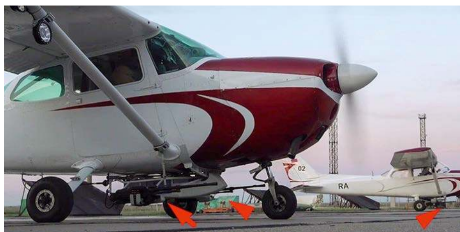
SZ FR zaczęły używać samolotów szkolno-treningowych i innych lekkich samolotów do walki z ukraińskimi dronami. Wzorem rozwiązań ukraińskich są to przeważnie dwumiejscowe Jaki-52, w których za pilotem siedzi strzelec z karabinkiem. Jednakże w materiale państwowej telewizji zaprezentowano dwa samoloty Cessna 172, które zostały uzbrojone w dwa karabiny maszynowe Kord kal. 12,7 mm zamontowane pod kadłubem.
