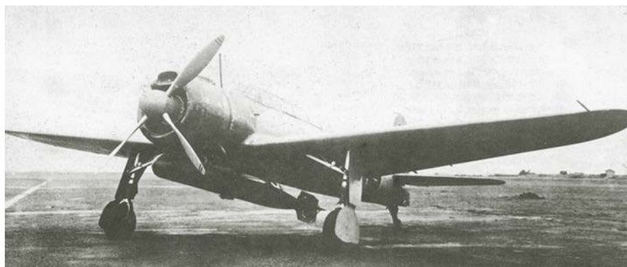
Pierwszy lub drugi prototyp B6N1. Torpeda podwieszona pod kadłubem wskazuje, że zdjęcie wykonano podczas wojskowych prób kwalifikacyjnych w Wydziale Prób w Locie Arsenalu Techniki Lotniczej Marynarki Wojennej w bazie Oppama koło Yokosuki w drugiej połowie 1942 roku.
