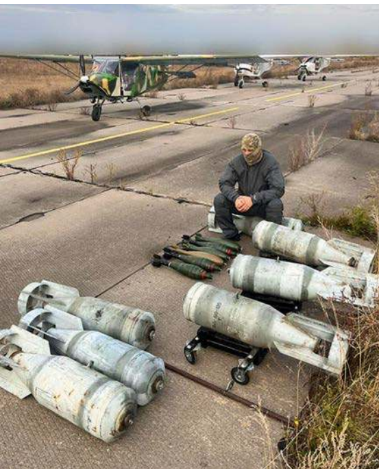
Ukraińskie drony samolotowe E-300 Enterprise podczas uzbrajania w bomby FAB-100 i pociski moździerzowe kal. 120 mm.
