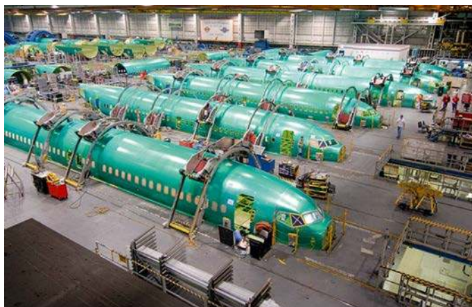
Produkcja kadłubów Boeingów 737 w zakładzie w Wichicie. Fot. Spirit AeroSystems
