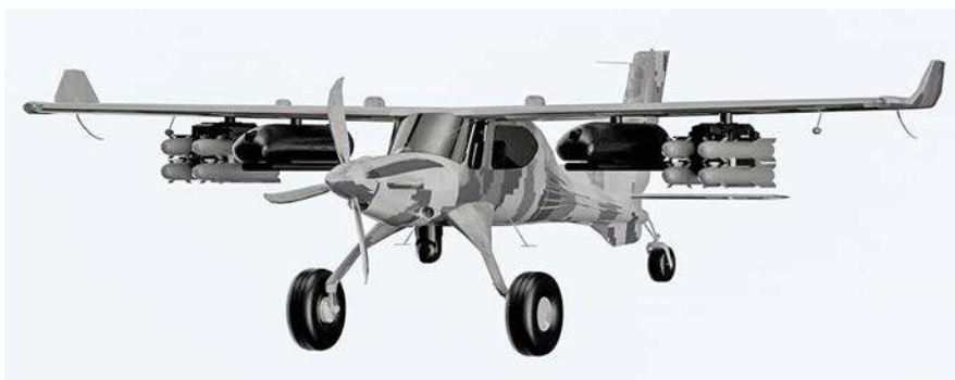
Wizja Wilgi Draco w pełnej konfiguracji bojowej, z pociskami kierowanymi i niekierowanymi oraz głowicą obserwacyjną pod kadłubem. Fot. Draco Aircraft
