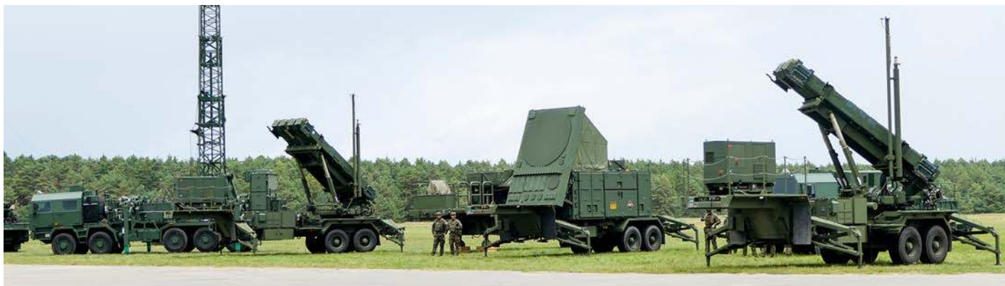
Elementy polskiego zestawu Patriot – dwie wyrzutnie, radar AN/MPQ-65 i maszt systemu łączności.
