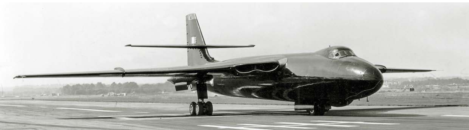
Prototyp Valianta B.2 (WJ954) różnił się od maszyn seryjnych wzmocnioną konstrukcją skrzydeł, zupełnie nowym podwoziem głównym z czterookolowymi wozkami i wydłużoną o 1,37 m przednią częścią kadłuba.
