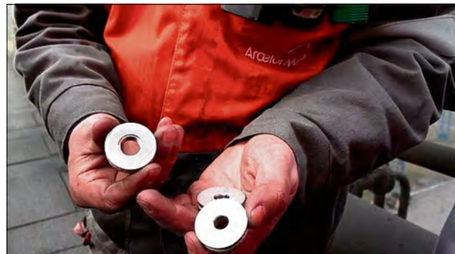
Zamiast szukać trudno dostępnej części, można ją zaprojektować i wydrukować w 3D. Tak od siedmiu lat dzieje się w zdzieszowickiej koksowni.
