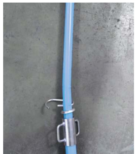
Fot. 1. Przykład podpory, która w trakcie badania wykazywała duże rezerwy nośności. Jednakże wybočenje uniemożliwia jej ponowne wykorzystanie. Dodatkowo, tak duże wygięcie powoduje u użytkownika poczucie zagrożenia. W takim przypadku trudno uznać za siłę niszczącą maksymalną wartość, jaką uzyska się w badaniu
