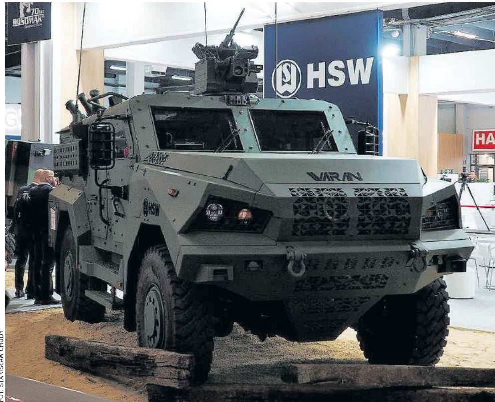
Taktyczny Pojazd Wielozadaniowy o układzie jezdnym 4x4 w wersji Wozu Dowodzenia
