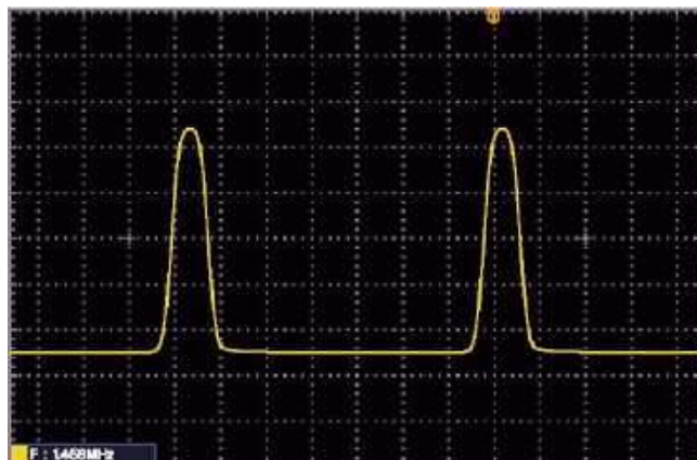
Okresowy impuls o współczynniku wypełnienia 10% jest ostatnim przykładem, który omawiamy (© 2021 Jos Verstraten)
