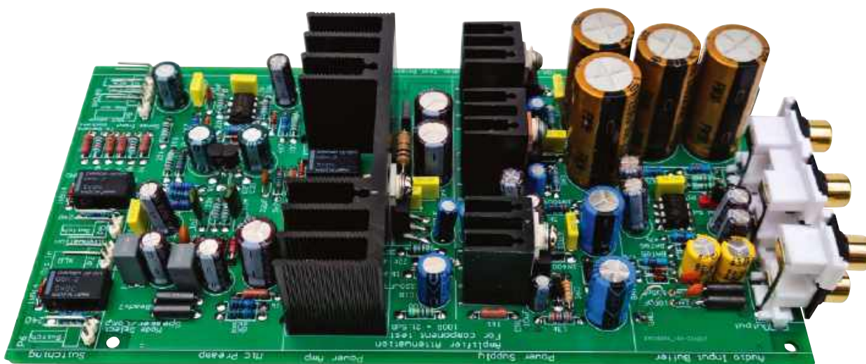
Zmontowana płytką drukowaną, gotowa do przyłączenia panelu przedniego poprzez osiem złączy kątowych. Złącza ułatwiają podłączanie i odłączanie, gdy układ jest już zamontowany w obudowie
