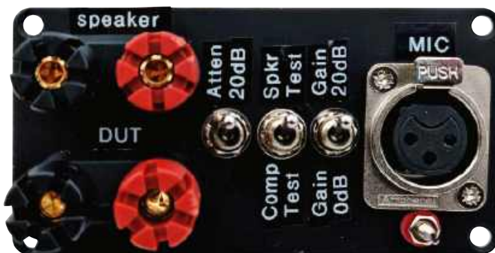
Fotografia 1. Widok zmontowanego panelu przedniego. Etykiety pomagają zapamiętać, do czego służą gniazda i przełączniki!
