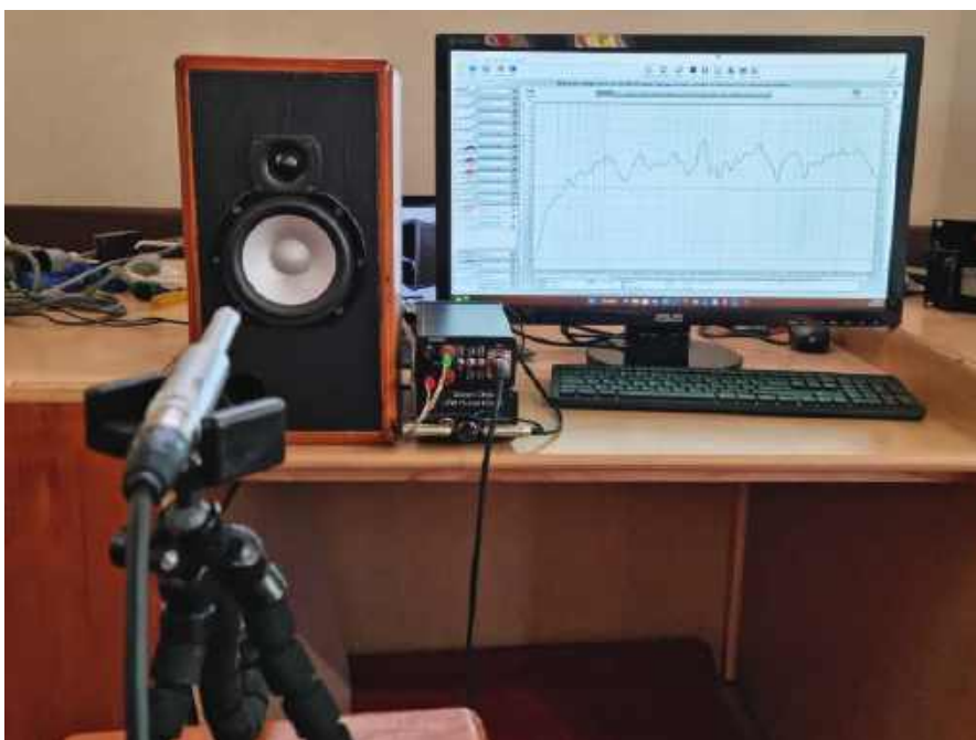
Przystawka testowa w działaniu – pomiar pasma przenoszenia półkowego zespołu głośnikowego
