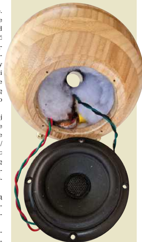
Fotografia 8. Kolumna tuż przed ostatecznym zamocowaniem głośnika, z luźno upchaną w środku watą akustyczną
