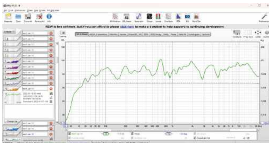
Zrzut ekranu 6. Wykres charakterystyki częstotliwościowej szerokopasmowego zestawu głośnikowego wykonany w programie REW. Tego rodzaju wyniki są nieocenione podczas projektowania i optymalizowania zestawów głośnikowych
