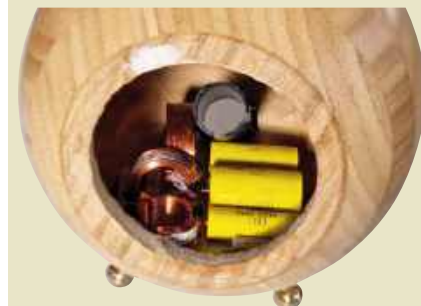
Fotografia 7. Zbliżenie pokazujące umiejscowienie płytki zwrotnicy zapewniające, że najbliższa cewka omija rurkę tunelu bass-reflex
