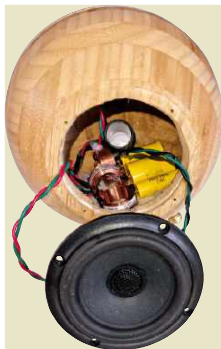
Fotografia 1. Widać, jak tunel bass-reflex, głośnik i zwrotnica są dopasowane do kulistej obudowy, która została wykonana poprzez sklejenie dwóch misek sałatkowych. Widać również pierścień wzmacniający z płyty MDF za okrągłym wycięciem na głośnik
