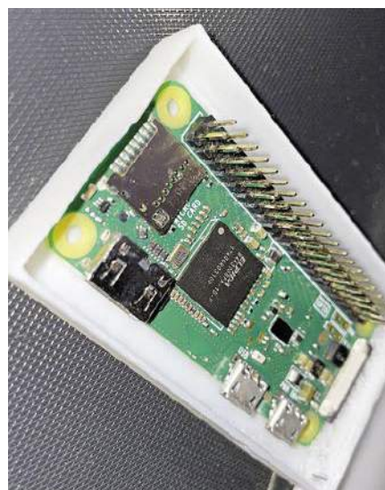
Rysunek 14. Złącze na Raspberry Pi dla podłączenia ekranu E-ink
