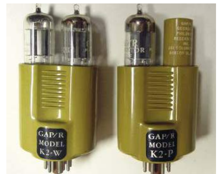
Rysunek 3. Popularny wczesny lampowy wzmacniacz operacyjny, Philbrick Researches K2-W
