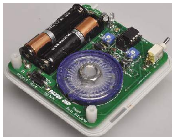
Ten widok pokazuje, w jaki sposób płytka drukowana jest przymocowana do pokrywki podstawy obudowy, ale co ważniejsze, pokazuje „tłumik” (obciążnik) przyklejony do poliestrowej membrany głośnika (w tym przypadku nakrętka ze stali nierdzewnej). Nie ulegaj pokusie użycia nakrętki ze zwykłej stali: są one magnetyczne i natychmiast przylgną do magnesu głośnika blokując membranę. Od Red. EdW: możesz oczywiście użyć nakrętki z też niemagnetycznego mosiądzu
