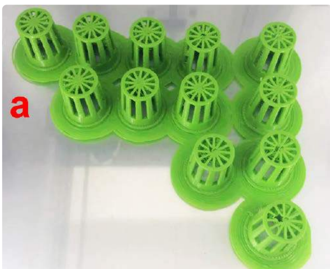
Rysunek 4. Tacki siatkowe wydrukowane w 3D (a) i gotowy zmontowany system testowy (b)
