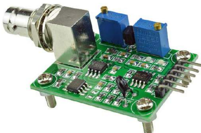
Rysunek 10. Kalibracja „Czujnika pH v1.1” jest skomplikowana (Źródło: [10])
