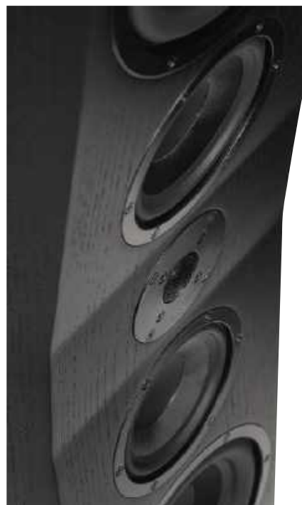
Głównym atutem konfiguracji Pinnacle jest układ symetryczny, kreujący pozorne punktowe źródło dźwięku. Dodano do tego wygięcie frontu służące „wyrównaniu czasowemu” wszystkich przetworników.
