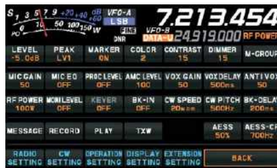
Fot. 3. Naciśnięcie punktu na ekranie pozwala na wybór ustawienia za pomocą gałki funkcyjnej. W przykładzie widocznym na ilustracji wybrany jest punkt RF POWER (moc w.cz.). Na dole w kolorze niebieskim wyświetlone są wywołania rzadziej używanych punktów menu
