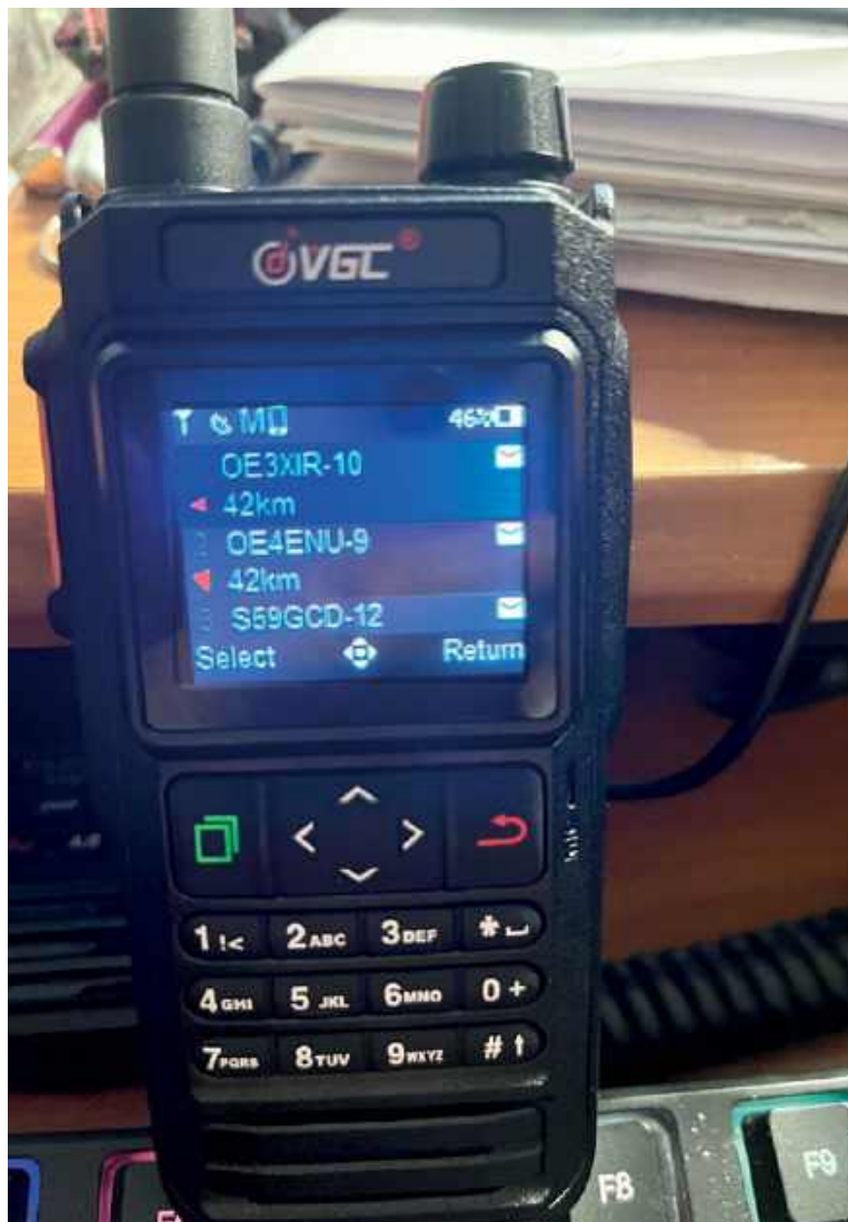
Fot. 2. Spis odebranych komunikatów APRS. Żaden z nich nie został jeszcze przeczytany – koperty są zamknięte. Symbol przenośnego komputera w górnej linii wyświetlacza informuje o połączeniu z programem HT
