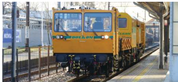
„Sisi” to nowoczesna szlifierka torowa Vulcano LGT 10M
