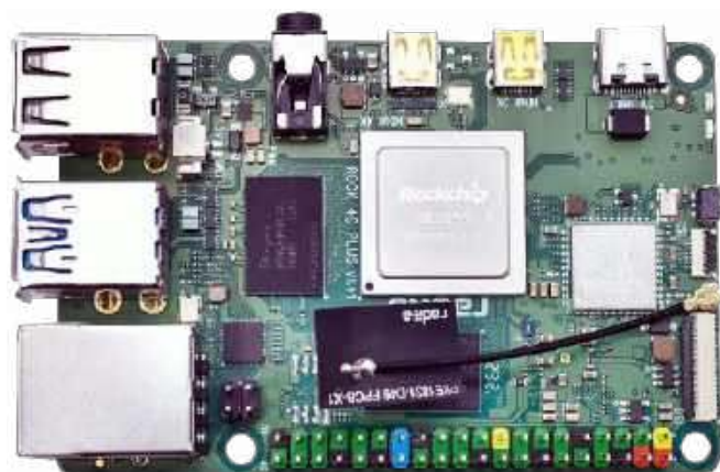
Fotografia 6. Komputer SBC typu ROCK 4C+ zbudowany na bazie układu SoC Rockchip RK3399 ( https://www.keyestudio.com/products/rock-4-model-c-4gb-single-board-computer-rockchip-rk3399-t-arm-cortex-a72 )
