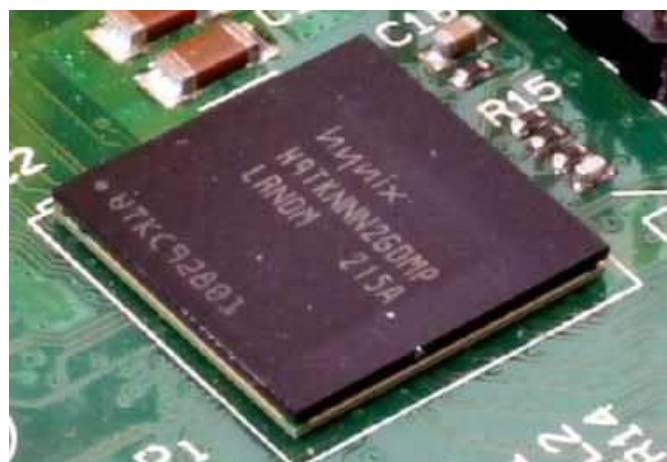
Fotografia 3. Procesor BCM2835 na płytce Raspberry Pi, wyposażony w pamięć SDRAM zamontowaną w technologii PoP ( https://de.wikipedia.org/wiki/Package-on-Package )
