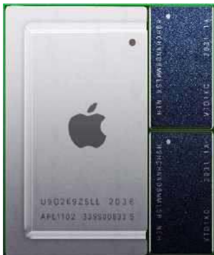
Fotografia 1. Zaawansowany układ SiP typu M1 od Apple ( https://en.wikipedia.org/wiki/Apple_M1 )
