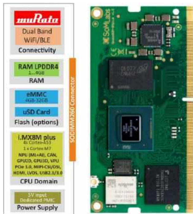
Rysunek 16. Moduł SpaceSOM-8Mplus z procesorem NXP i.MX8M Plus Quad ( https://wiki.somlabs.com/index.php?title=SpaceSOM-8Mplus_Datasheet_and_Pinout )
