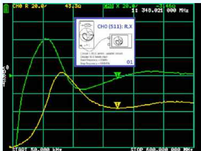
Rysunek 100. Wynik pomiaru obwodu nr 1 na płycie RF Demo-Kit
