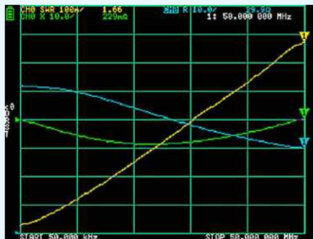
Rysunek 114. Wykresy parametrów SWR, R i X sztucznego obciążenia AVT3210/2
