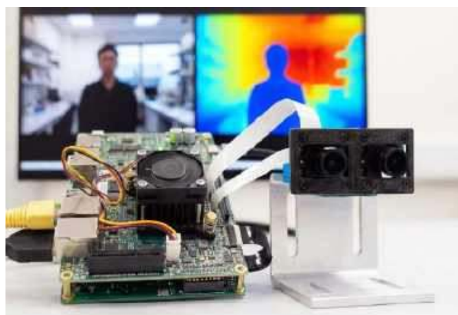
Fotografia 7. Płytkę uruchomieniową z układem RZ/V2H do testowania aplikacji typu 3D vision ( https://deepvisionconsulting.com/a-realtime-3d-application-on-the-renesas-rz-v2h/ )
