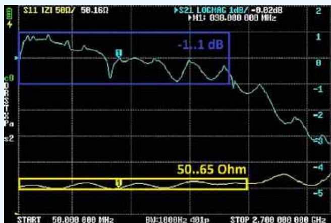
Rysunek 130. Charakterystyki częstotliwościowe tłumienia i SWR wzmacniacza LNA 50...4000 MHz/20 dB
