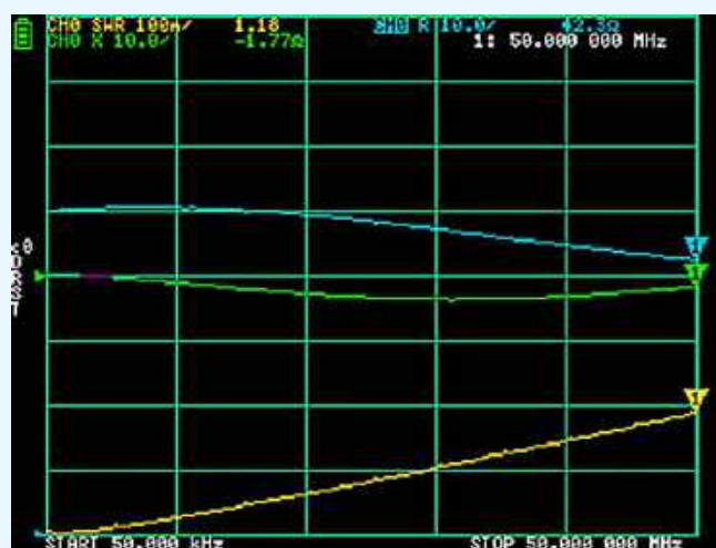
Rysunek 113. Wykresy parametrów SWR, R i X sztucznego obciążenia AVT3210/1
