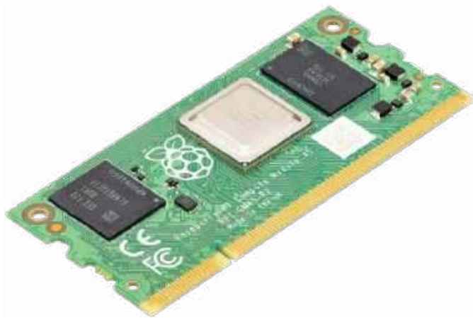
Fotografia 11. Moduł RPi Compute Module 4S (CM4S) typu SO-DIMM ze złączem krawędziowym, zgodny z formatem DDR2 stosowanym we wcześniejszych wersjach: CM1, CM3 i CM3+ ( https://www.raspberrypi.com/products/compute-module-4s/ )
