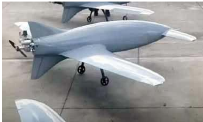
Fotografia 6. Uj-26 Bober – dron latający w układzie kaczki, oferujący dzięki temu lepsze parametry lotu. Ze względu na mniejszy rozmiar głowicy z ładunkiem wybuchowym, zwykle jest stosowany do precyzyjnych ataków
