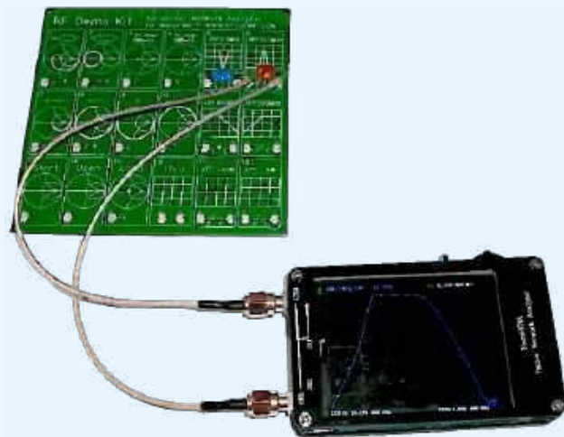
Fotografia 23. Pomiar filtru ceramicznego na płycie RF Demo-Kit wykonany analizatorem nanoVNA
