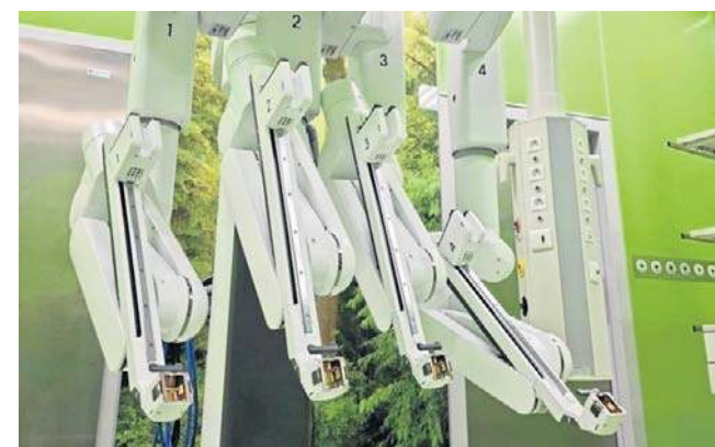
Robot chirurgiczny to rodzaj manipulatora z konsolą
