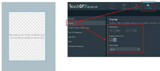
Rysunek 11. Konfiguracja orientacji wyświetlania i bitowej głębi kolorów TouchGFX Designer
