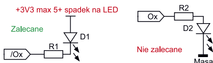
Rysunek 9. Zalecany sposób dołączania diod LED
