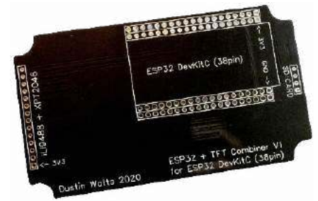
Fotografia 1. Opcjonalna płytka do połączenia ekranu i mikrokontrolera
