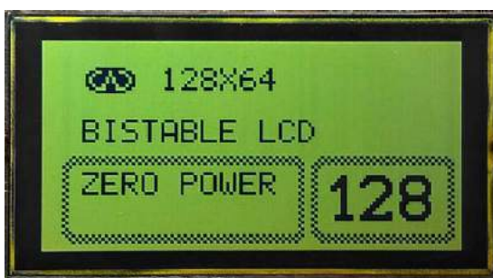
Fotografia 7. Wyświetlacz bistabilny LCD
