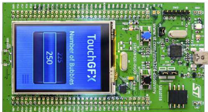
Fotografia 1. Program testowy uruchomiony na module STM32F429I Discovery
