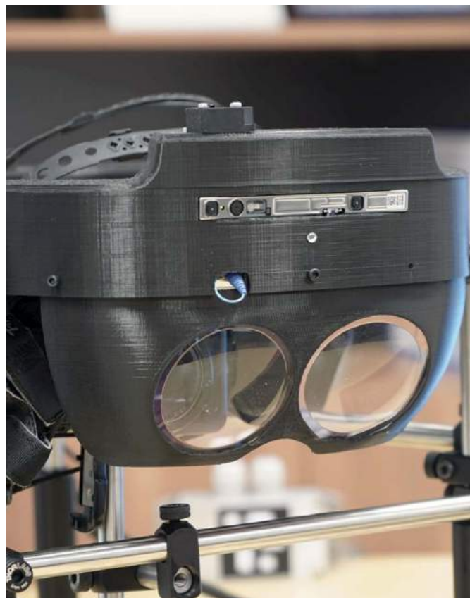
Fotografia 3. Prototyp gogli holograficznych do systemu rzeczywistości rozszerzonej
