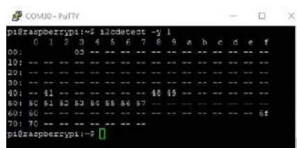
Rysunek 4. Detekcja układu SC16IS752 z użyciem i2ctools
