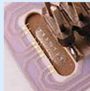
Fotografia 3. Tensometry krzemowe na metalowej membranie struktury w technologii krystal bond [8]
