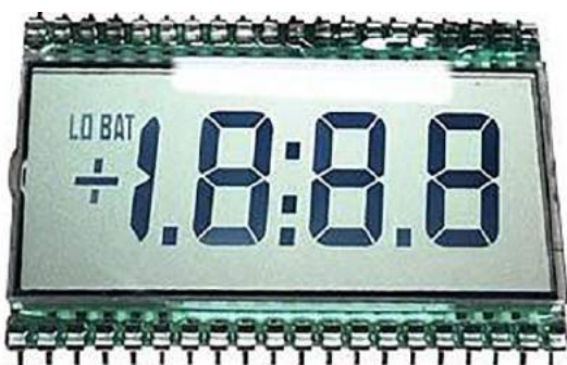
Fotografia 6. Wyświetlacz segmentowy LCD
