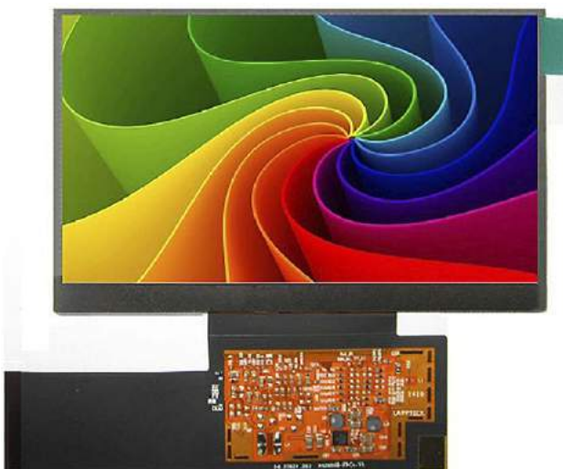
Fotografia 2. Wyświetlacz kolorowy OLED
