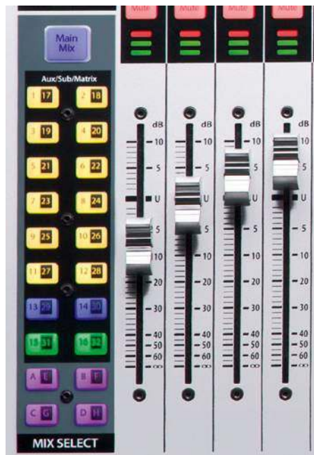
Skrajnie z lewej strony, obok tłumików lewego banku, znajduje się zestaw przycisków, z których każdy przyporządkowany jest do danej szyny wyjściowej.
