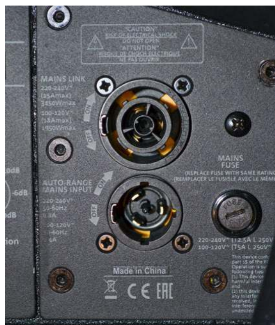
Na mniejszej części panelu znajdują się tylko gniazda do podłączenia kabla zasilającego z wtykiem PowerCON TRUE1 (wejście i wyjście-„podaj dalej”) oraz gniazdo bezpiecznika
