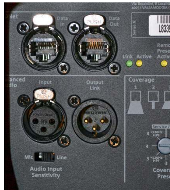
Na drugiej, większej części panelu znajdują się dwa gniazda XLR – męski i żeński – którym doprowadzamy sygnał audio, oraz dwa złącza Ethercon sieci RNet.
