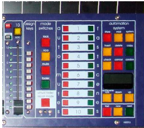
Ilustracja 12. Sterowanie systemem automatyki konsolety Heritage 3000.
