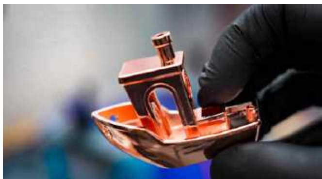
Fotografia 9. Wydruk 3D galwanizowany elektrolitycznie ( https://t.ly/rLNIC )
