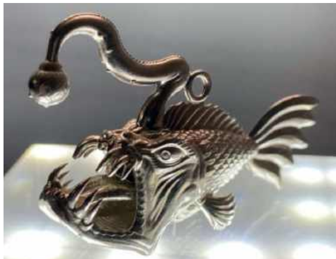
Fotografia 1. Detal wytworzony metodą odlewania z wosku traconego ( https://t.ly/hOj0X )
