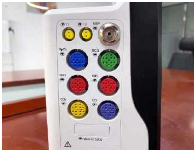
Fotografia 19. Panel gniazd wejściowych w kardiomonitorze. Warto zwrócić uwagę na różnice w ułożeniu otworów w gniazdach kodowanych różnymi kolorami – jest to najprostszy, mechaniczny sposób ochrony przed omyłkowym podłączeniem niewłaściwego czujnika bądź elektrod do danego portu ( https://t.ly/R14HU )
