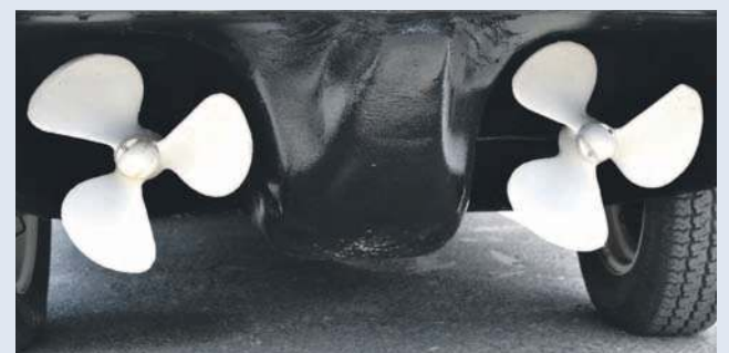
Na wodzie napędzają amficara dwie śruby
