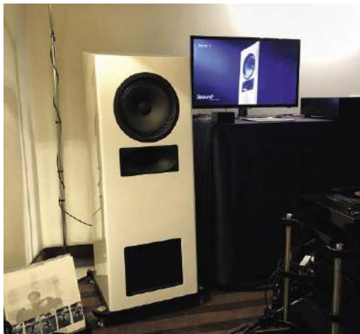
Kolejna polska marka Sisound licytuje wysoko. Dwudrożne kolumny Fortis S mają się wyróżniać efektywnością powyżej 100 dB przy impedancji 8 Ω. Sisound oferuje do kompletu oczywiście wzmacniacze lampowe, a także źródła (w tym odtwarzacz strumieniowy), przedwzmacniacz, stoliki, kabelki...
