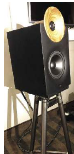
Audio Video Show to scena nie tylko dla firm-celebrytów, ale też dla nowych inicjatyw, które tędy właśnie próbują wypłynąć na szersze wody. Firma Aretai pochodzi z Łotwy, a model Contra to najmniejsza (jedyna podstawkowa) konstrukcja z drewnianym falowodem przetwornika wysokotonowego.
