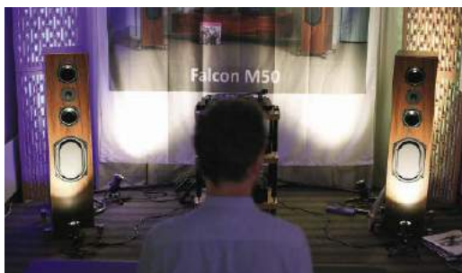
Monitor LS3/5A inspirował wielu, specjalistów w tym temacie jest firma Falcon Acoustics, ale na tym jej możliwości i zainteresowania się nie kończą. Model M50 to konstrukcja trójdrożna i wolnostojąca, z parą przetworników B110 (tym razem w roli średnionotonowych), kopułką wysokotonową oraz słynnym owalnym woofer B139. Wszystkie te komponenty można kupić u Falcona „luźnym”, do własnych projektów DIY.
