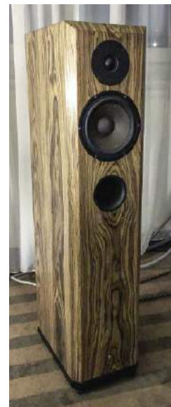
Kolumny Active One firmy AudioLens nie mają wprawdzie żadnej soczewki akustycznej, pod względem akustycznym to klasyczny układ dwudrożny, a ich nowoczesną funkcjonalność określa konstrukcja aktywna. Wystarczy podłączyć źródło. Cyfrowe.
