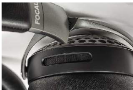
Szczeliny w górnych częściach obudów muszli wiążą się z zainstalowaniem mikrofonów.
