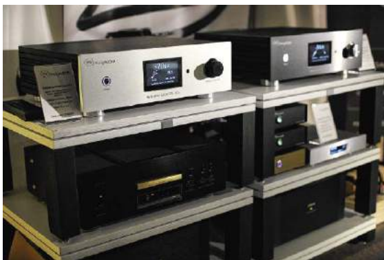
MuzgAUDIO – pisownia oryginalna i z naszymi mózgami nie ma nic wspólnego – tworzy oryginalne przetworniki cyfrowo-analogowe. DAC-01S ma wyjścia zbalansowane i obsługuje strumień PCM 384 kHz oraz DSD512. Źródłem mogą być np. komputery (wejście USB), ale tuż nieopodal przystanął wysłużony (lecz wciąż sprawny i kultowy) transport Teac VRDS.
