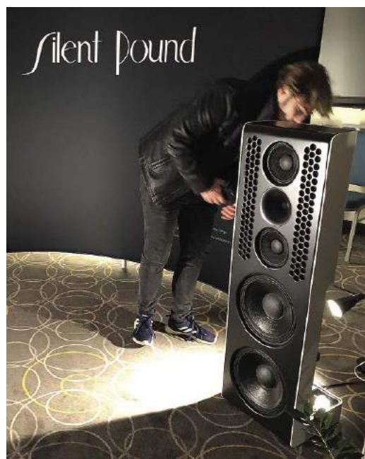
Zespoły głośnikowe z otwartą odgradą to zjawisko wciąż rzadkie, ale już przez audiofilów docenione. Francuska manufaktura Silent Pound zaprezentowała nowy model (na razie bez nazwy), z dwoma 30-cm niskotonowymi, dwoma 20-cm średniotonowymi i 25-mm kopułką wysokotonową. Jak na dipol to wcale nie jest przesada.
