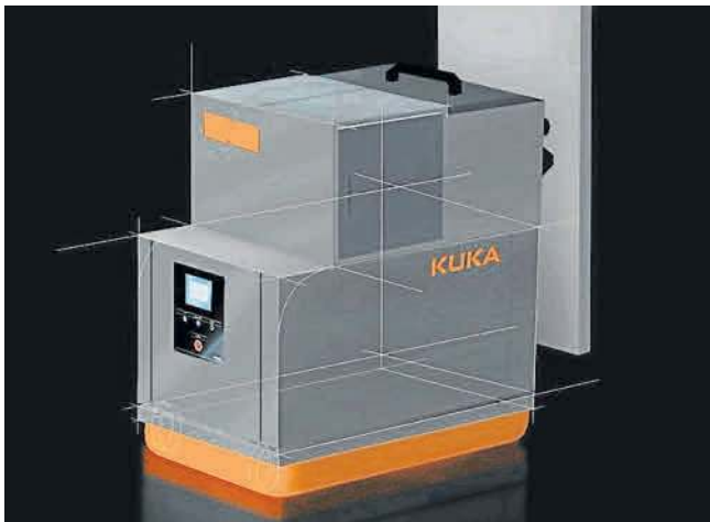
Robot, nad którym pracują lubelscy inżynierowie, ma wymiary 1,25 x 0,63 x 1,1 m. Ma rozpylać preparaty wirusobójcze
