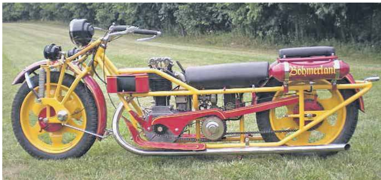
Bohmerland, znany też jako Cechie, to czeski motocykl produkowany od 1924 do 1939. Został niemal w całości zaprojektowany przez Albina Leibischa, włącznie z długą ramą i nowoczesnymi pełnymi kołami. Prędkość maksymalna 121 km/h. Eksperymentalny egzemplarz wykonany dla armii miał przewozić czterech żołnierzy. Model Langtouden jest najdłuższym ze wszystkich motocykli, jakie kiedykolwiek weszły do produkcji – ma 3,2 m
