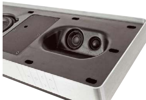
Beosound Stage to soundbar samowystarczalny, nie przewidziano asysty subwoofera, sekcja niskotonowa ma aż cztery 10-cm głośniki
