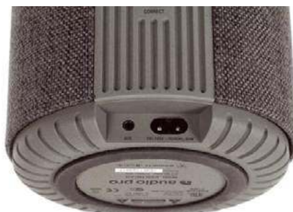
A10 łączy się tylko przez Wi-Fi, nie ma tu gniazda LAN, ale jest analogowe wejście mini-jack.
