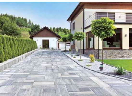
📌 Płyty betonowe można układać ciasno lub z szeroką spoiną, wypełnioną np. kruszywem. LIBET, BRUK-BET
