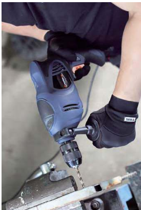
🔧 W stabilizacji pracy wiertarki pomaga dodatkowa rękojeść. YATO, LANGE ŁUKASZUK (KRESS)
