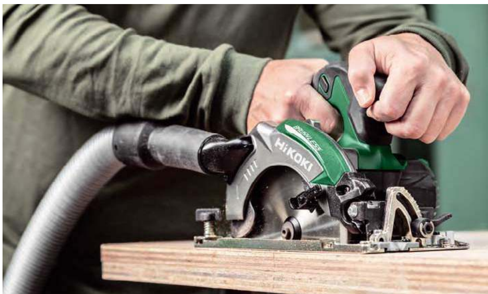
● Pilarka podłączona króćcem do odkurzacza pochłaniającego pył. HIKOKI
