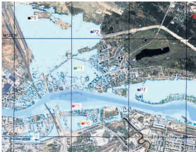
Symulacja poziomu fali powodziowej z Martwej Wisły na Stogach
